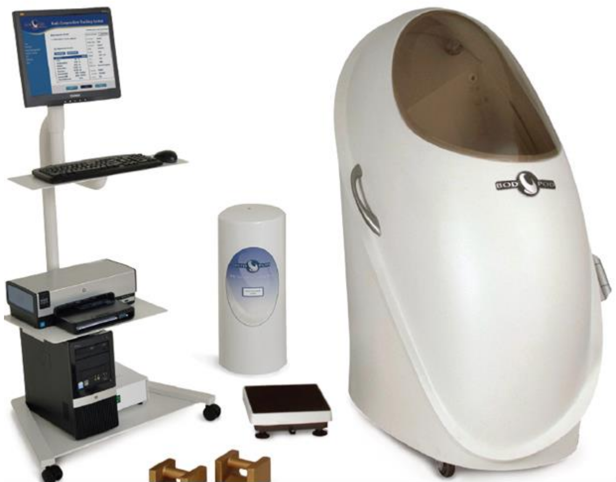
Рисунок 75. Современная система автоматизированного определения состава тела BOD POD Gold Standard.
