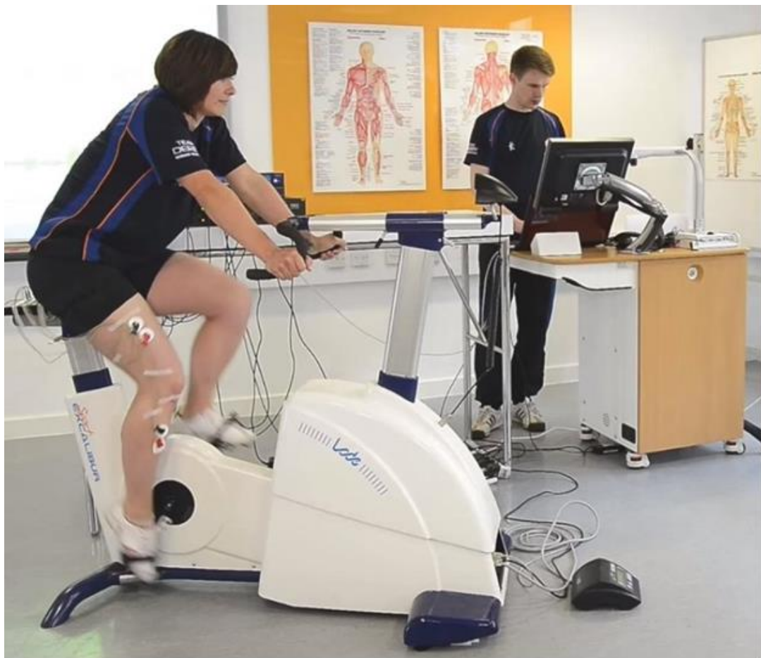
Рисунок 3. Общий вид установки, обеспечивающей регистрацию ЭМГ на нижней конечности во время физической мышечной нагрузки и результат записи: электромиограмма мышц ( vastus lateralis и tibialis anterior , латеральная широкая мышца бедра и передняя большеберцовая мышца)
