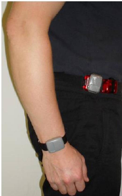
Рисунок 33. Расположение акселерометра на талии и правом запястье: GT1M и GT3X+ (близкое расположение акселерометров GENEА и GT1M, расположенных над правым бедром; монтирование GENEА на правом запястье) [Rowlands A.V., Stiles V.H. Accelerometer counts and raw acceleration output in relation to mechanical loading. Journal of Biomechanics 45 (2012) 448–454]
