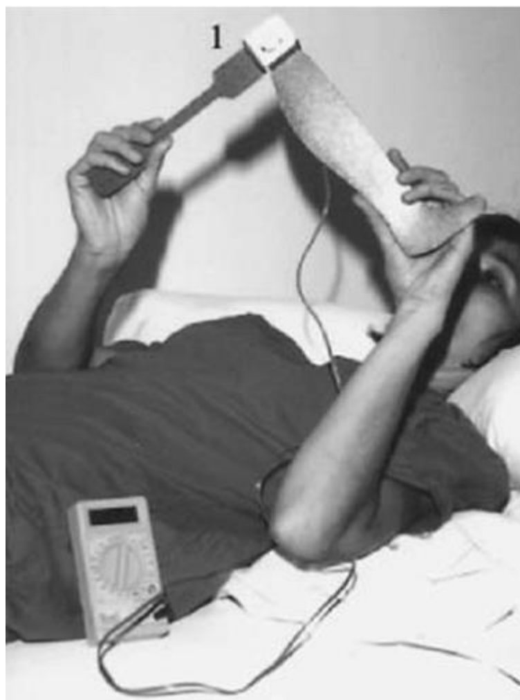
Рисунок 32. Удержание в руках электрогониометра для количественного определения положения сустава 2 (JPS 2).
