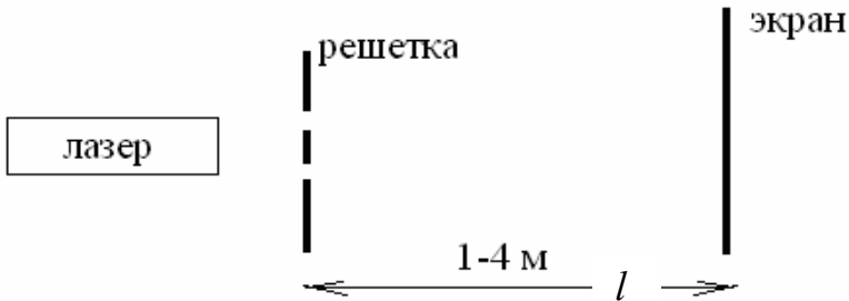
Рис. 5. Схема используемой установки с дифракционной решеткой
