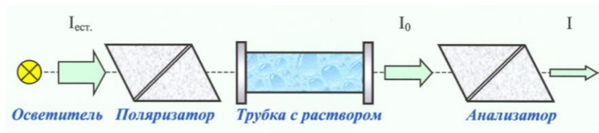
Рис. 2. Схематическое устройство сахариметра
