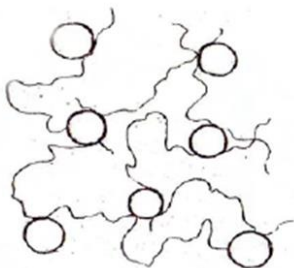
Рис. 31. Схема флокулы, образованной по мостиковому механизму
