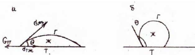
Рис. 32. Капля воды на поверхности твердого тела: а – смачивание; б - несмачивание
