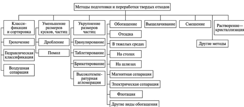
Рис. 48. Методы первичной подготовки и переработки твердых отходов вышедших из употребления резиновых технических изделий, отвалов галита (каменной соли) и фосфогипса, отходов древесины, некоторых пластмасс, строительных материалов. В качестве основных технологических показателей дробления рассматривают степень и энергоемкость дробления
