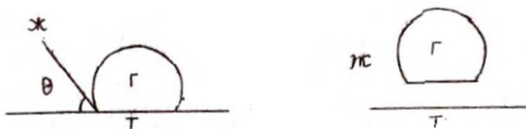
Рис. 33. Схема отрыва пузырька от поверхности твердого тела
