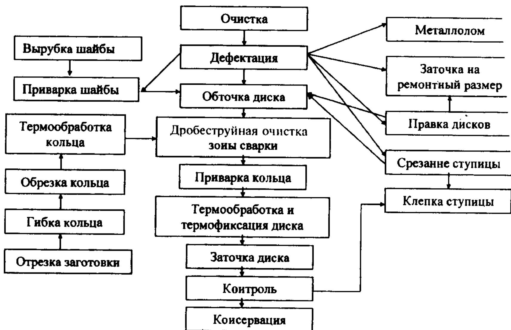
Рис. 6.19. Схема ТП восстановления дисков сошиков сеялок и лушильников
