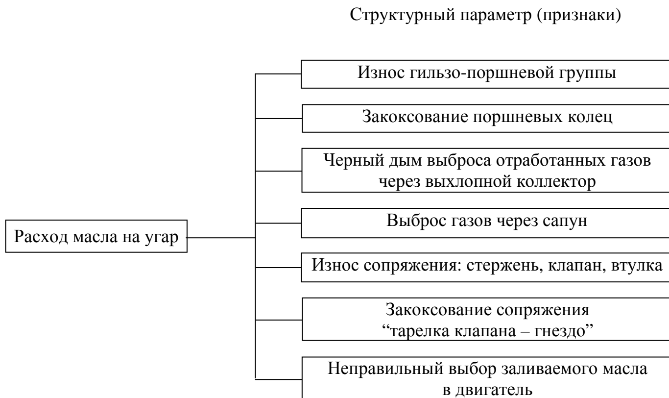
Схема 3.5. Схема выявления причин угара масла в двигателе ЗИЛ-130
