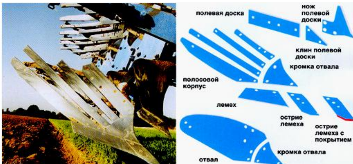
Рисунок 2.4 – Корпус, применяемый на плугах фирмы «Lemken» (Германия)*
