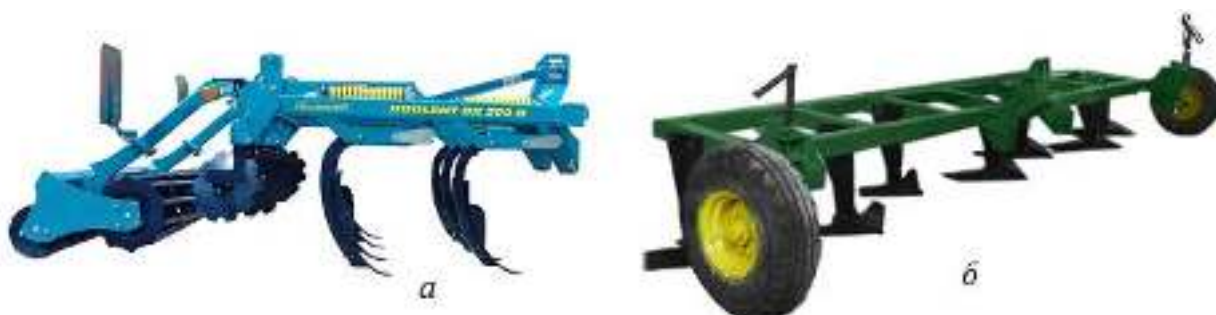
a – чизельный культиватор Duolent, б – плоскорез-глубокорыхлитель ПГ-7
