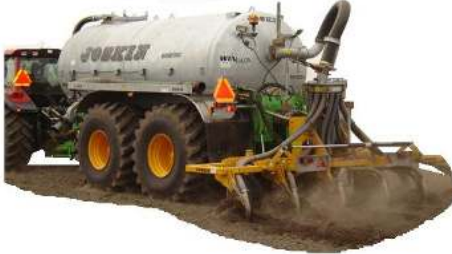
Рисунок 4.31 – Машина фирмы «Joskin» (Komfort 2) с адаптером для внутрипочвенного внесения удобрений
