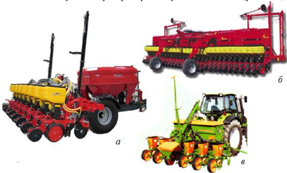
a и б – сеялки точного высева «Hatzenbichler»; в – сеялка модели ED фирмы «Amazonen-Werke»
