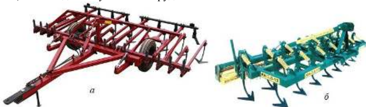
a – прицепной культиватор КПГ-4; б – навесной культиватор КН-3,8
