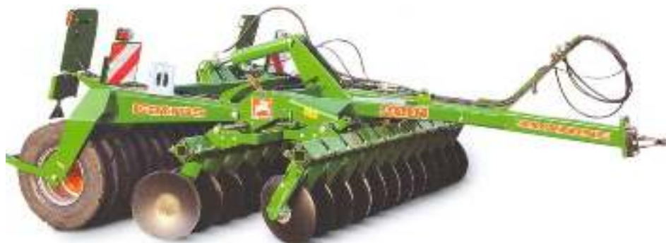
Рисунок 2.37 – Прицепная дисковая фронтальная борона Catros 3001 (Amazone)
