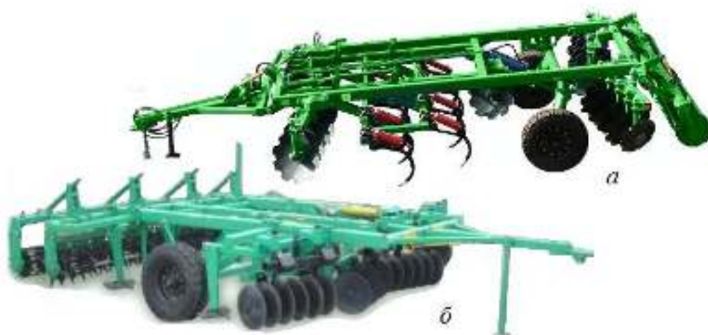
a – чизельный агрегат ДИЧ; б – агрегат комбинированный АКМ
