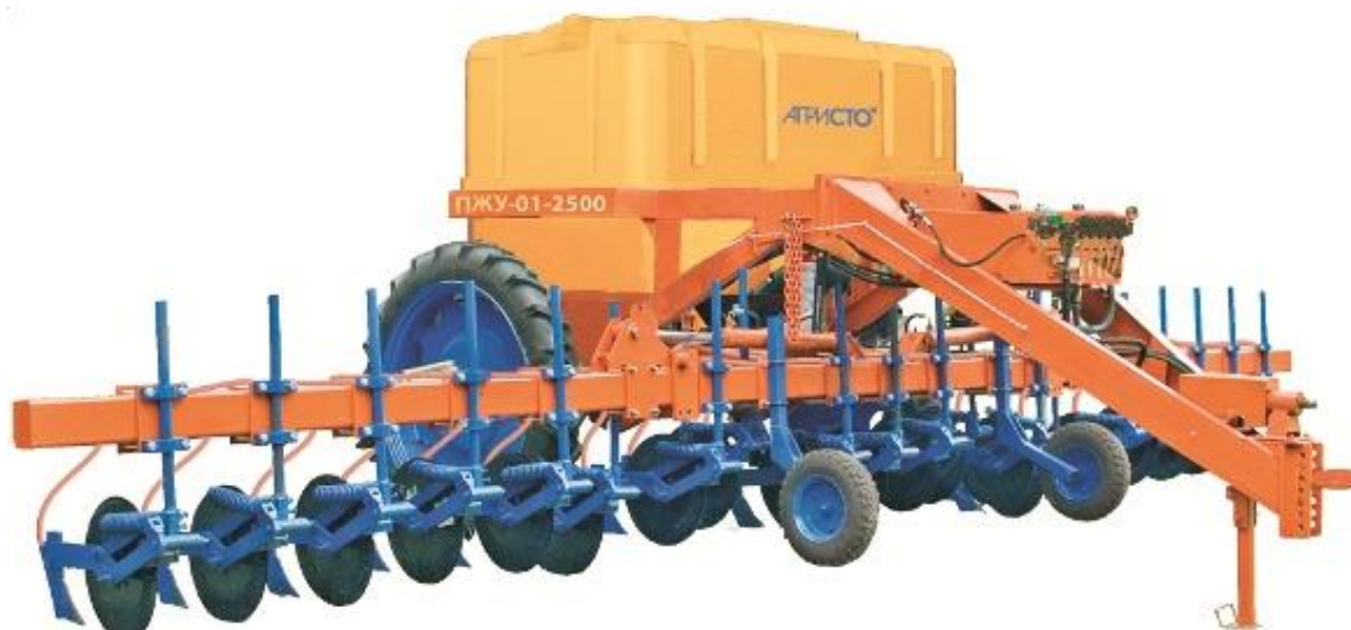
Рисунок 4.19 – Подкормщик (растениепитатель) жидких минеральных удобрений ПЖУ-01-2500 (ООО фирма «Агрохиммаш»)
