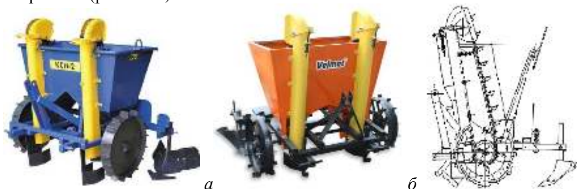
Рисунок 3.36 – Картофелесажалки КСН-2 (а) и VKS-2 (б) с цепочно-ложечными высаживающими аппаратами
