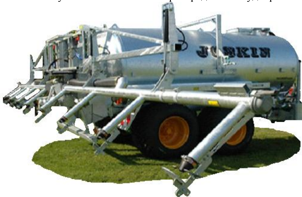
Рисунок 4.30 – Машина фирмы «Joskin» со штангово-дефлекторной распределительной системой
