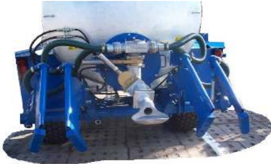
Рисунок 4.28 – Разливочное устройство машины для внесения ЖОУ
