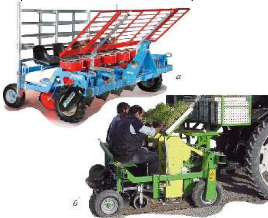
а – рассадопосадочная машина PRACTICA с револьверными высаживающими аппаратами; б – рассадопосадочная машина EASY с вертикальными высаживающими аппаратами
