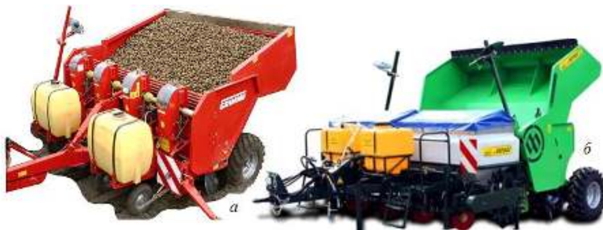
Рисунок 3.37 – Прицепные картофелесажалки Grimme VL20KLZ (а) и Hassia SL4BZS
