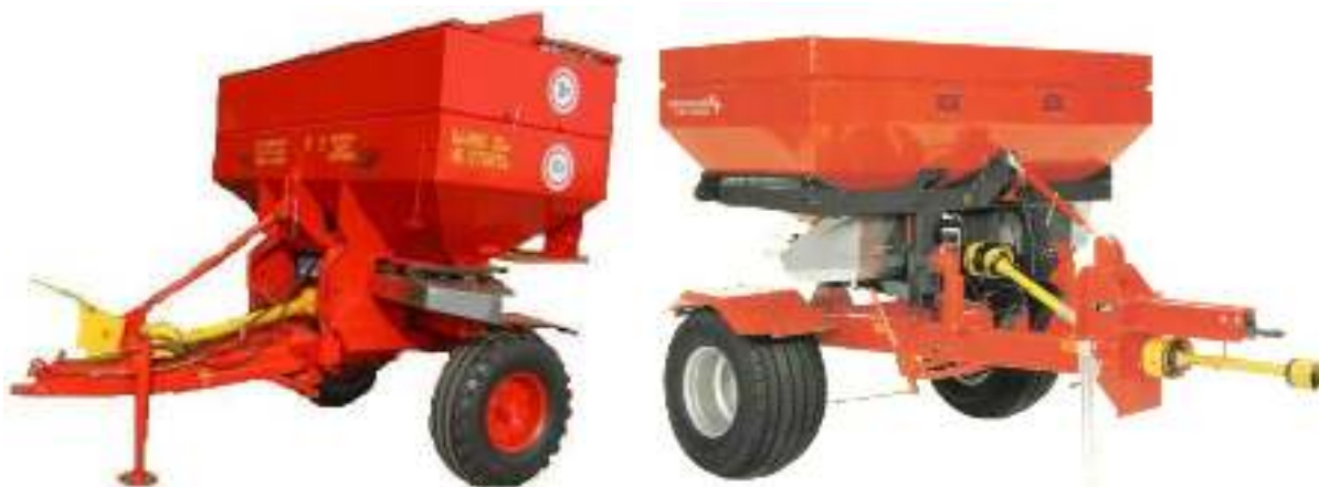
Рисунок 4.7 – Разбрасыватели минеральных удобрений РУ-3000 (ООО «Бобруйскагромаш») и Vison на двухколесном шасси
