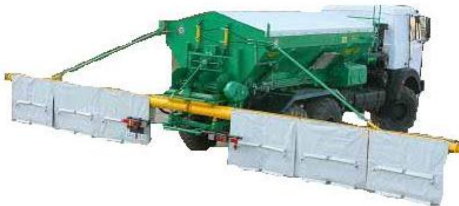
Рисунок 4.17 – Самоходная машина химизации МХС-10 (ОАО «Бобруйскагромаш»)
