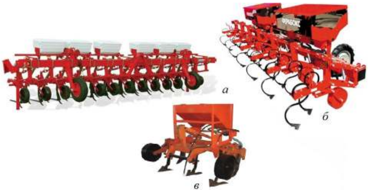
a – пропашной культиватор КРН-5,6А «Альтаир»; б – культиватор КМУ-7; в – тяжелый культиватор КНВ-3
