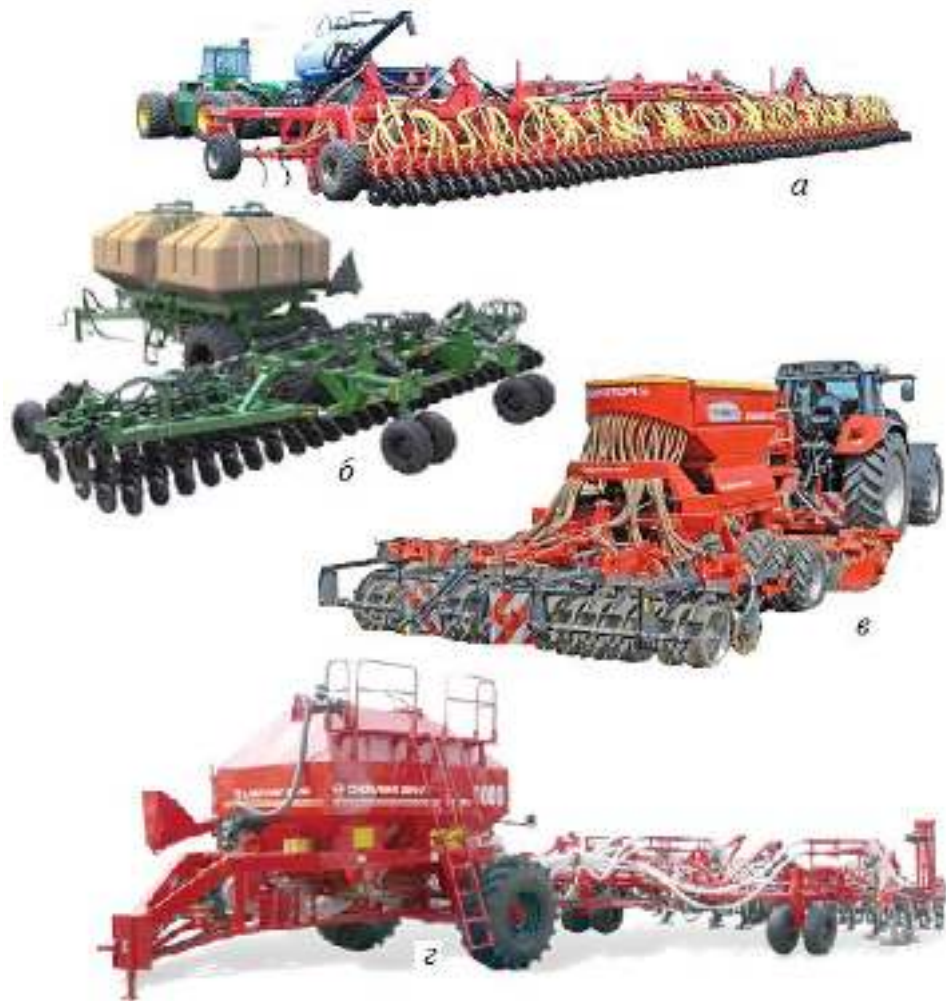
а – многофункциональный посевной комплекс Terminator; б – пневматическая зерновая сеялка Great Plains СТА-4000HD; в – посевной комплекс Terrasem 4000 T Starr («Pottinger» (Австрия)); г – пневматическая сеялка-культиватор Сириус 10
