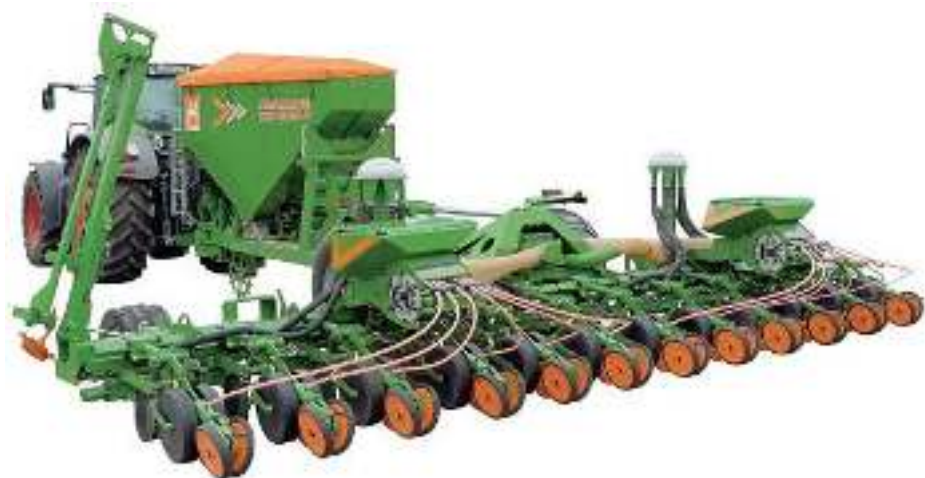
Рисунок 3.15 – Сеялка точного высева EDX 9000 фирмы Amazone
