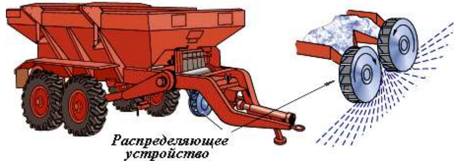
Рисунок 4.12 – Машина для внесения минеральных удобрений СТТ-10
