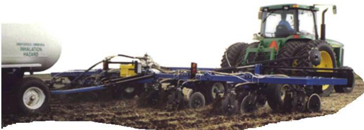
Рисунок 4.20 – Агрегат для внесения аммиака Dalton-DLQ-8
