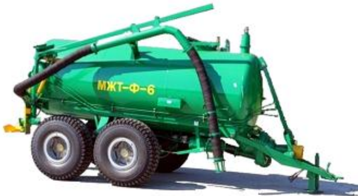
Рисунок 4.27 – Машина МЖТ-Ф-6Ш для внесения жидких органических удобрений
