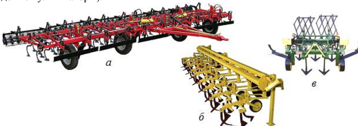
a – культиватор для сплошной обработки почвы КПО-9, б – пропашной культиватор КРН-5,6; в – садовый культиватор КВО-3
