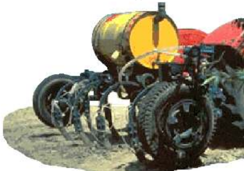
Рисунок 5.19 – Агрегат для внесения жидкого фумиганта в почву самотеком
