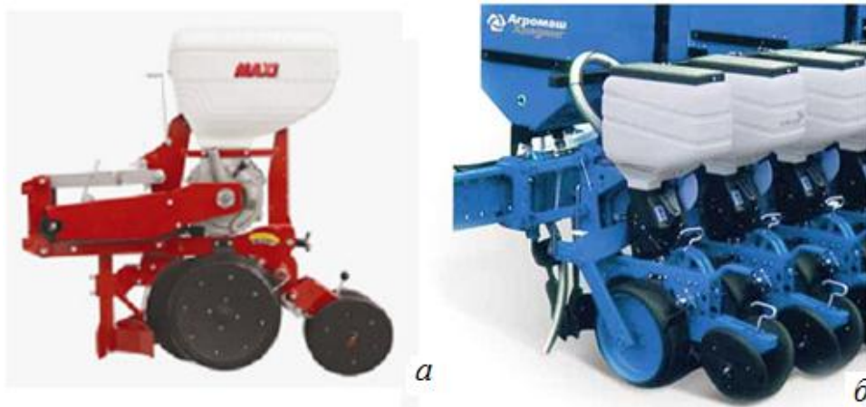
а – пневматическая сеялка МАХИ (Mascar); б – сеялка СТВО 18/12 (холдинг Агроташ)
