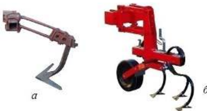
Рисунок 2.18 – Параллелограммные подвески рабочих органов культиваторов
