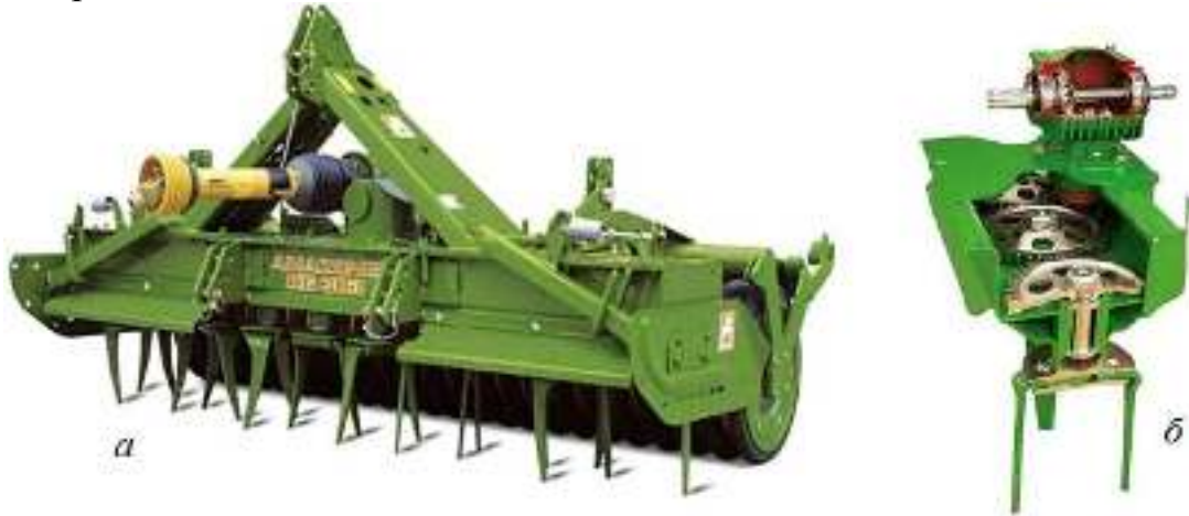
а – культиватор KG 303 фирмы «Amazone»; б – рабочие органы
