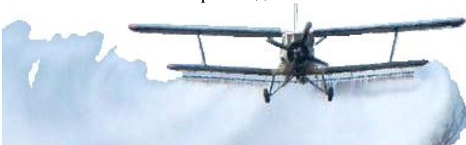
Рисунок 5.10 – Авиационный опрыскиватель на базе самолета АН-2
