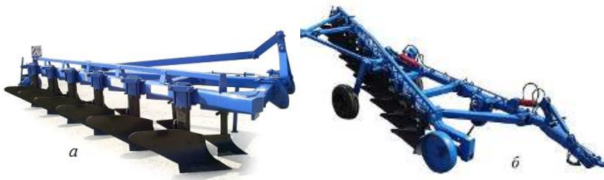
а – плуг навесной ПНУ-6х35ИП (ОАО «Светлоградагромаш»); б – прицепной плуг серии ПП (ООО НПХ «Реста+К»)
