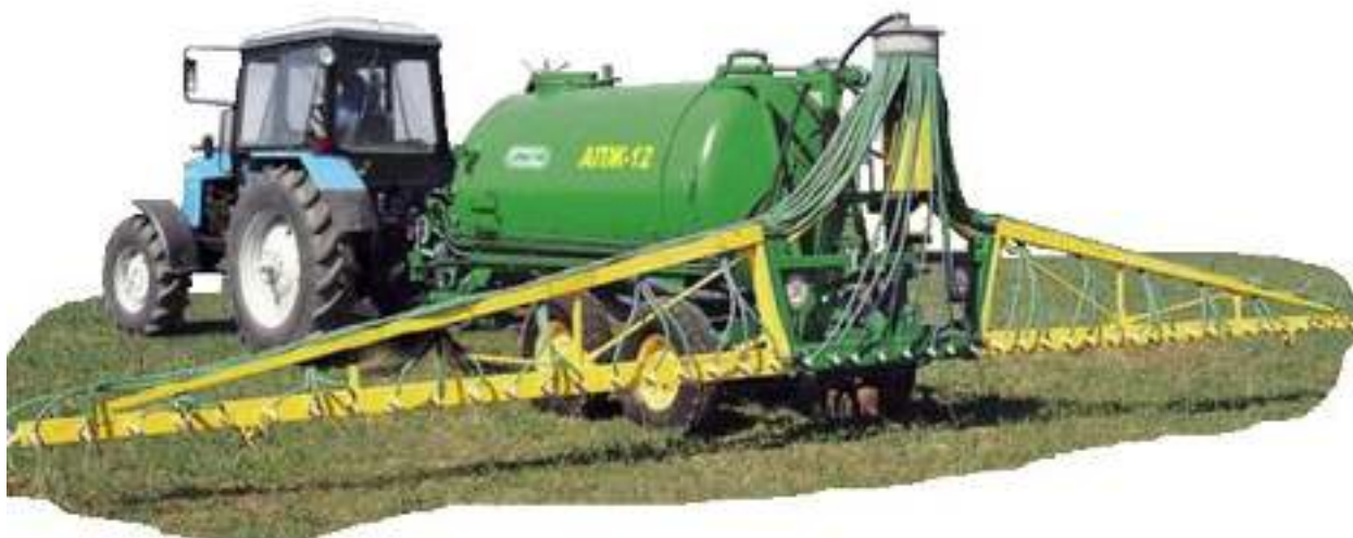
Рисунок 4.18 – Машина для внесения жидких минеральных удобрений АПЖ-12 (ОАО «Бобруйскагромаш»)
