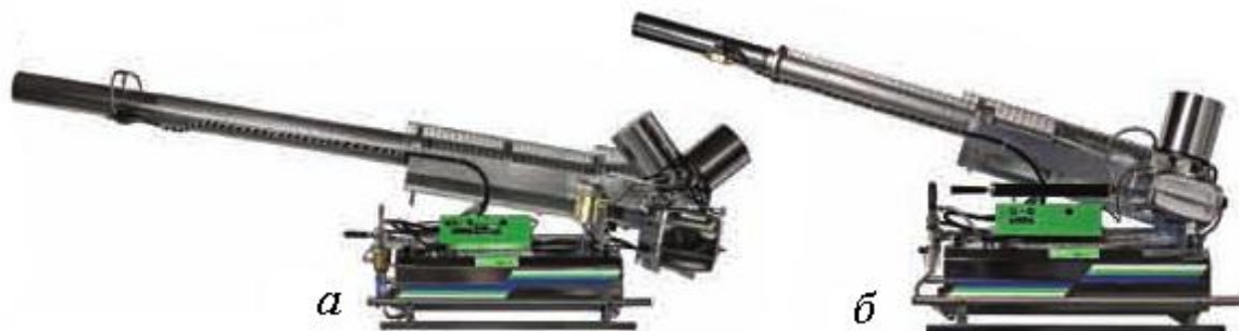
Рисунок 5.14 – Термомеханический генератор горячего тумана TF 160 HD «Jumbo» и TF 95 HD
