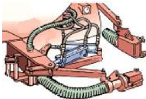
Рисунок 4.16 – Распыливающее устройство машины АРУП-8
