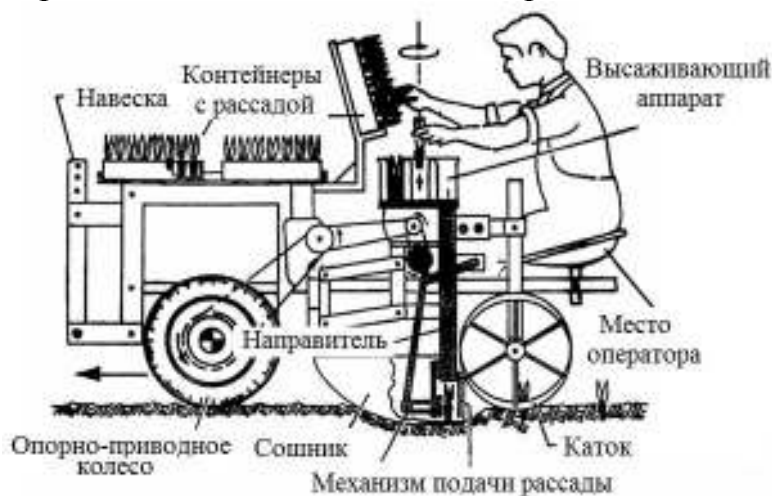
Рисунок 3.41 – Рассадопосадочная машина с револьверными аппаратами
