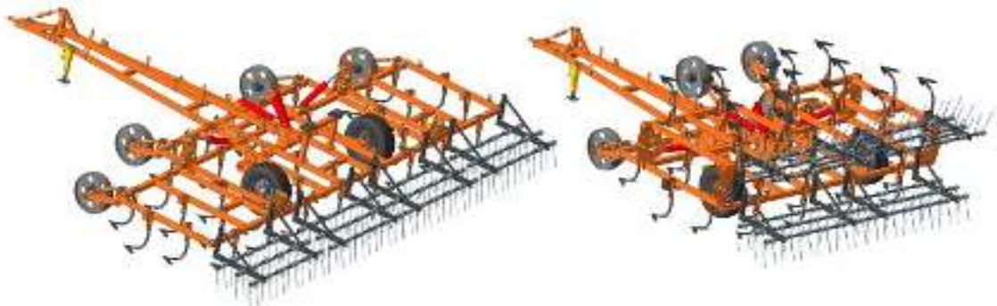
Рисунок 2.16 – Культиватор прицепной паровой гидрофицированный КППГ-8 (ЗАО «Логия» г. Лабинск Краснодарского края)
