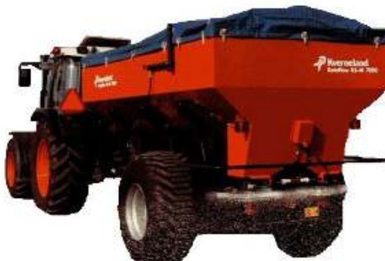
Рисунок 4.6 – Разбрасыватель минеральных удобрений Penton RS-M 7000
