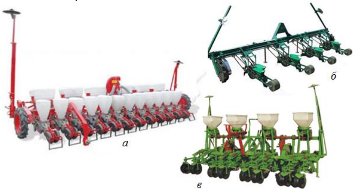
а – свекловичная сеялка УПС-12 (ОАО «Червона Зирка», Украина); б – сеялка овощная СОМ-4/2×70 («Ирбис», Украина); в – двустрочная хлопковая сеялка СЧХ-4Б (компания «Агриком», Ташкент)
