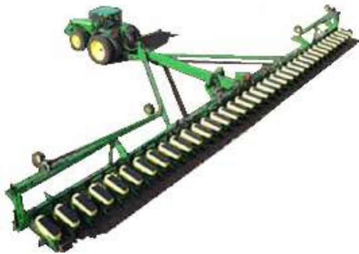
Рисунок 3.22 – Прицепная тридцатишестирядная сеялка компании «John Deere»
