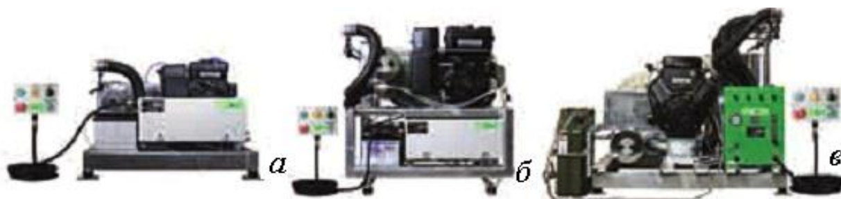
Рисунок 5.16 – Аэрозольные генераторы U 10 HD-M (а), U 15 HD-M (б) и U 40 HD-M (в)
