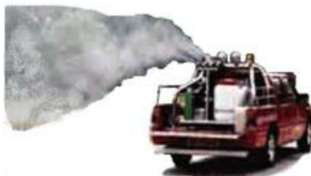
Рисунок 5.17 – Аэрозольный генератор U 15 HD-M на базе автомобиля
