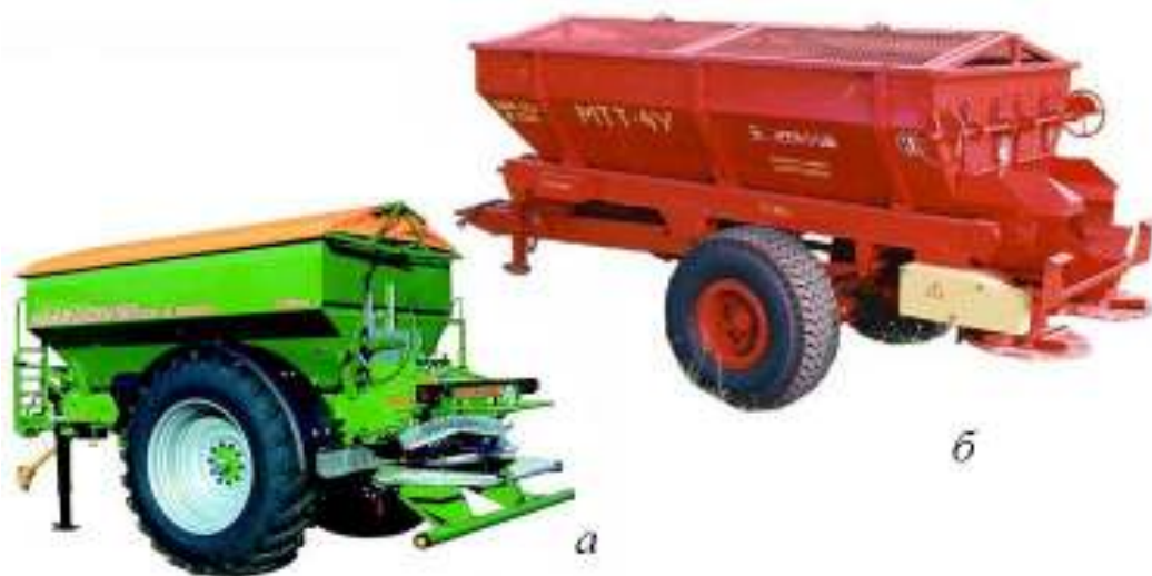
Рисунок 4.4 – Машина для внесения твердых минеральных удобрений (туков) МТТ-4У (а) и разбрасыватель удобрений AMAZONE серии ZG-B (б)
