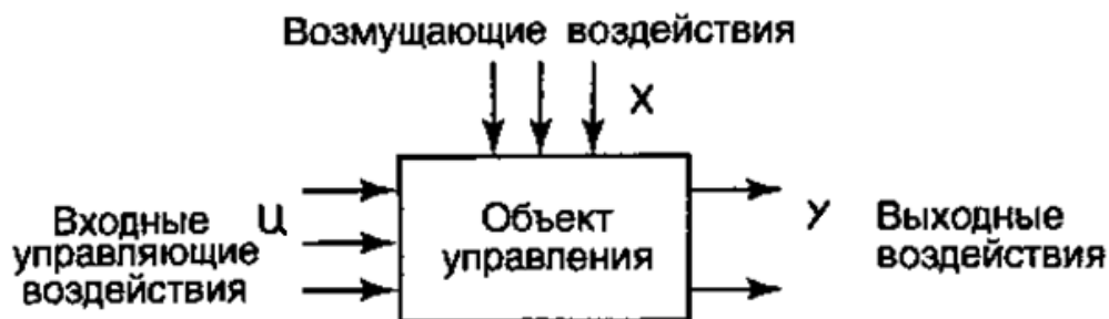
Рисунок 6.2 – Схема двигателя как объекта управления
