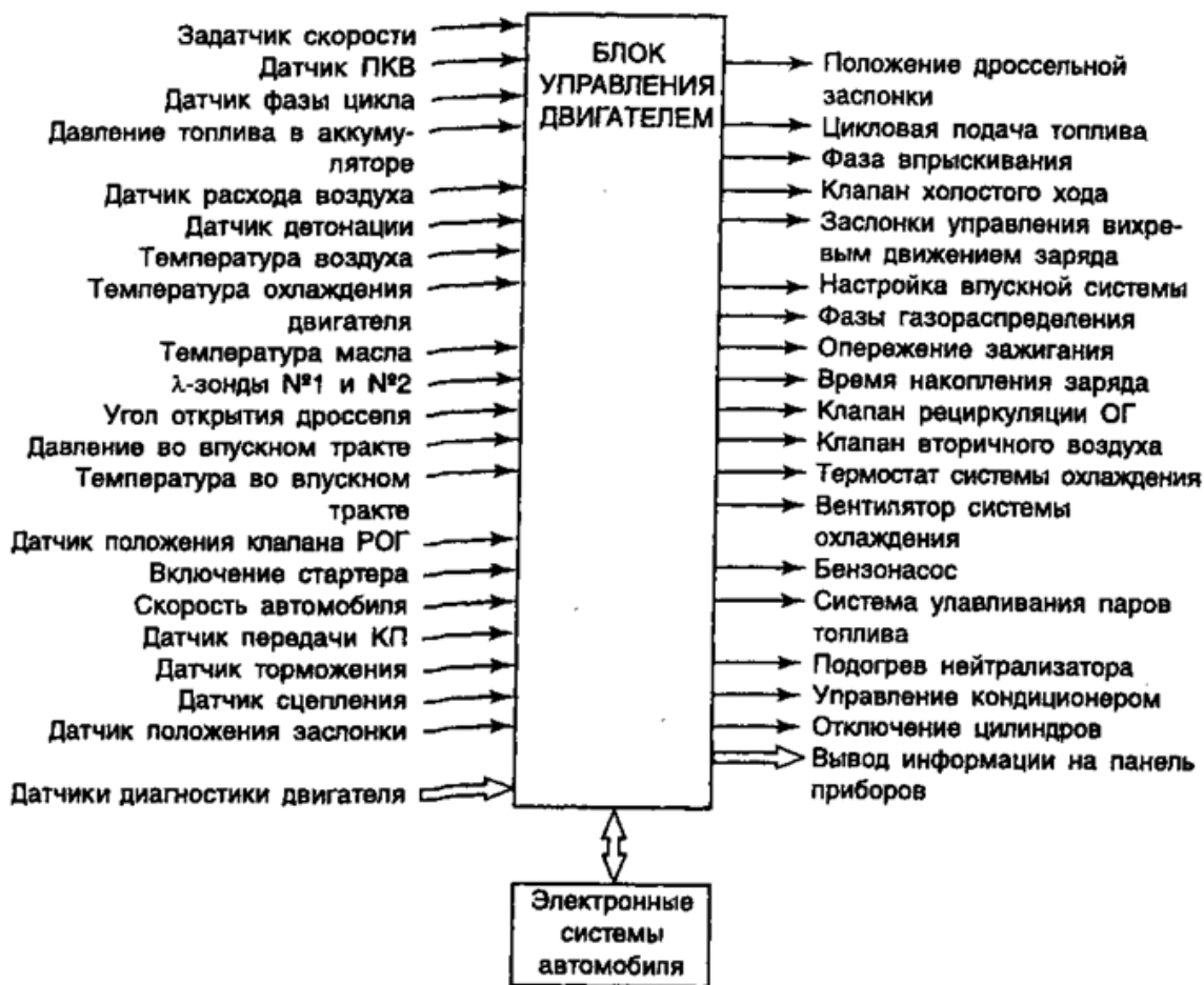
Рисунок 6.9 – Информационное обеспечение и функции комплексной системы управления бензиновым двигателем с распределенным впрыскиванием топлива
