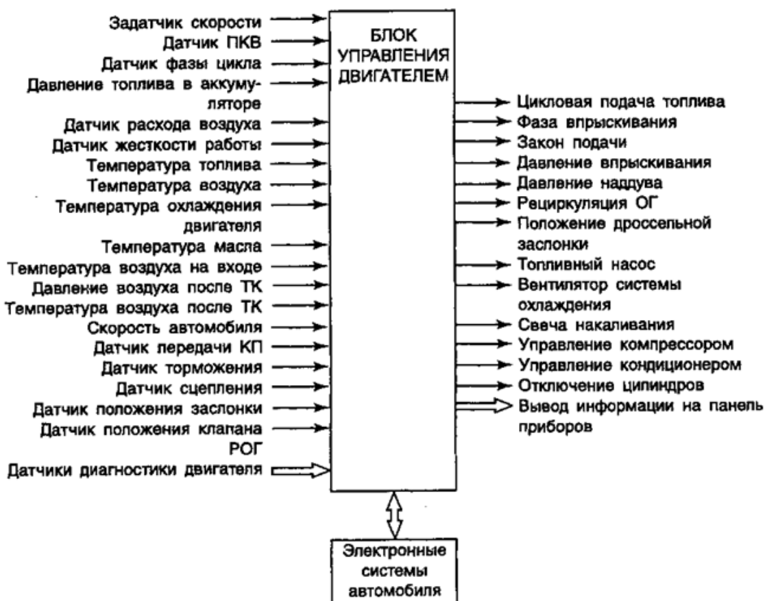
Рисунок 6.8 – Информационное обеспечение и функции комплексной системы управления дизелем с аккумуляторной системой питания
