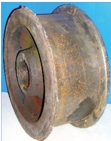
Изношенный опорный каток трактора
