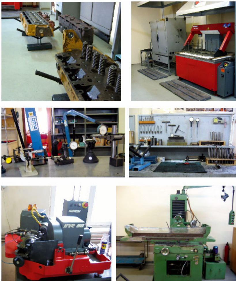
Рис. 4.2.9. Ремонт головок блока цилиндров двигателей отечественной и зарубежной техники на высокоточном оборудовании SERDI (Франция)
