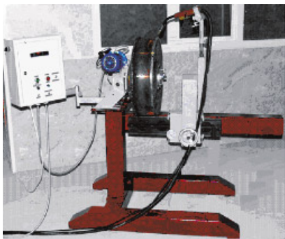
Электродуговая наплавка цилиндрических поверхностей опорных катков
