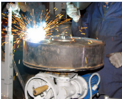
Электродуговая наплавка торцевых поверхностей опорных катков
