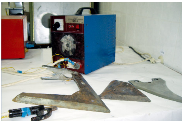
Специальный электродуговой трансформатор на 300А с осциллятором для упрочнения деталей
