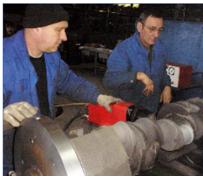
Визуальный осмотр напыленного слоя
