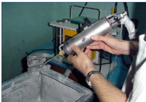
Холодное газодинамическое напыление пазов обоймы
