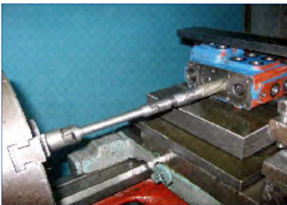
Механическая обработка золотникового отверстия в корпусе
