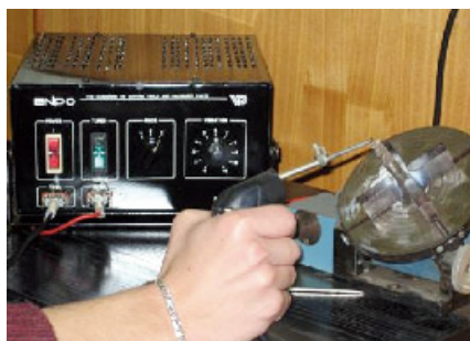
Рис. 3.5.4. Электроискровое нанесение износостойкого покрытия на фрезу ручным вибратором
