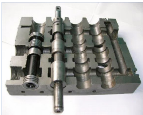
Корпус распределителя P100 (в разрезе)
