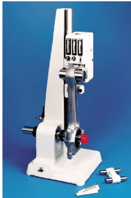
Рис.4.4.1. Приборы для проверки эллипсности, конусности и бочкообразности отверстий в нижней головке шатуна, измерения межцентрового расстояния двигателей
