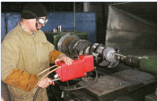
Наладка металлизатора перед напылением
