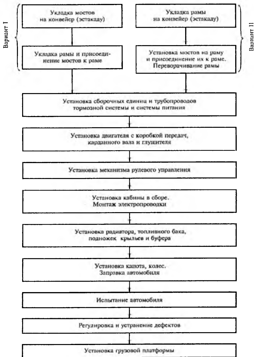
Рис. 6.6. Схема технологического процесса сборки грузовых автомобилей на потоке
