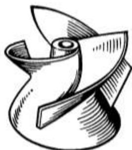
Рис. 2.28. Диагональное рабочее колесо открытого вида (без переднего диска)
