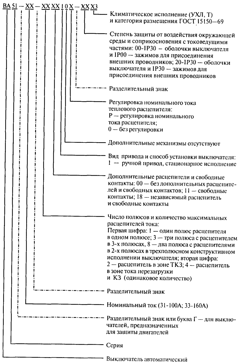
Рис. 1.64. Структура условного обозначения выключателя типа ВА-51 на номинальные токи 100 и 160 А
