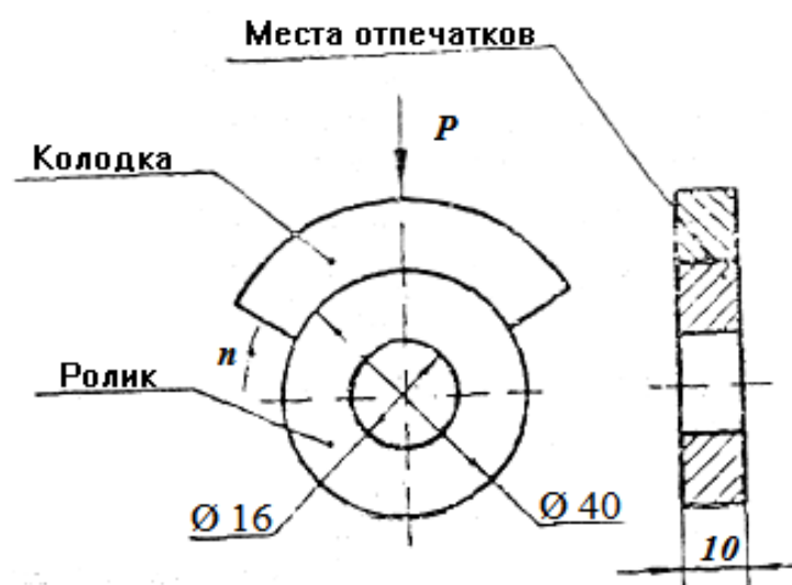
Рис. 5. Схема установки деталей для изнашивания
