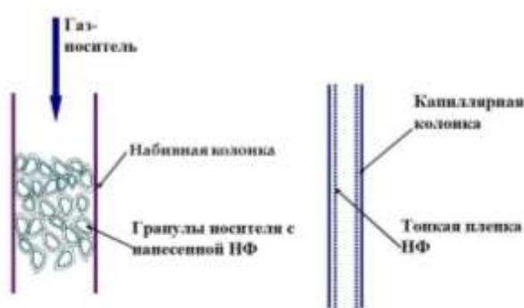
Рис. 22. Колонки для газожидкостной хроматографии
