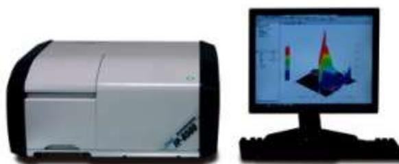
Рис. 28. Спектрофлюориметр EP-8500
