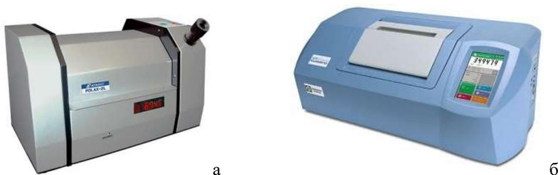
Рис. 29. Поляриметры: а - Atago POLAX-2L, б - ADP 600
