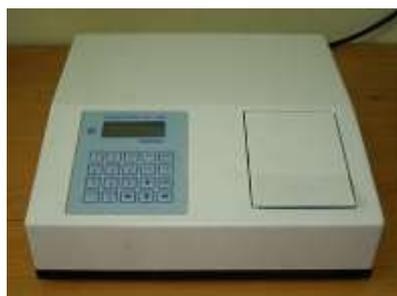
Рис. 27. Флюориметр «Флюорат 02-3М»
