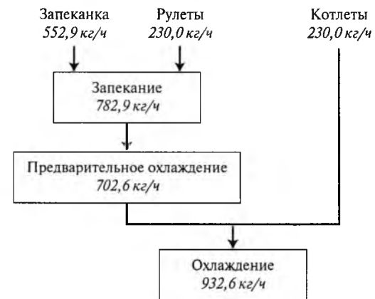
Рис. 39. Пооперационная технологическая схема участка тепловой обработки кулинарной продукции на поточной линии
