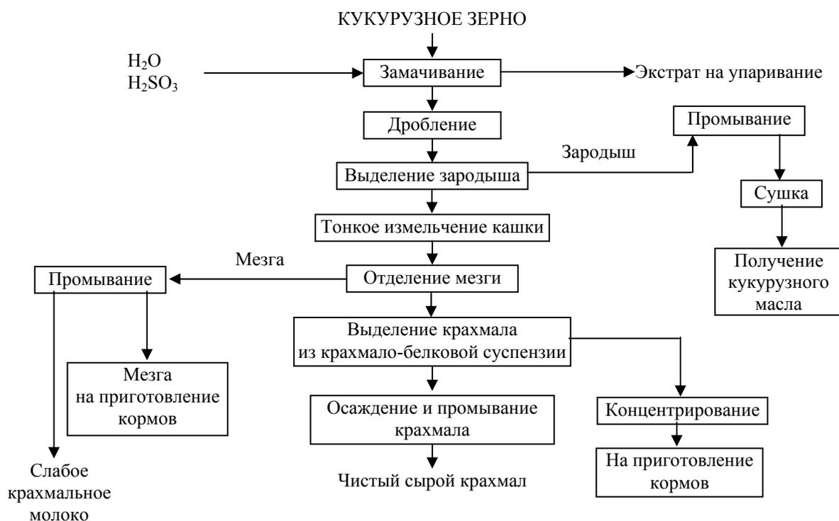
Рис. 56. Технологическая схема получения сырого кукурузного крахмала
