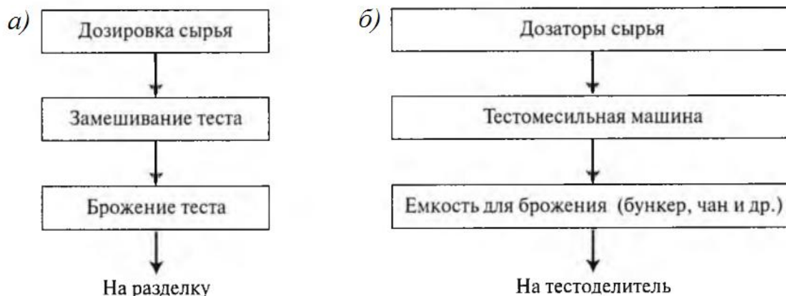
Рис. 4. Схема участка приготовления теста: а) функциональная; б) структурная
