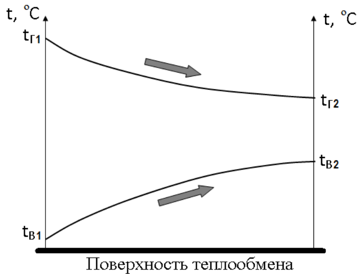
Рис. 1. График распределения температур вдоль поверхности теплообмена прямоточного теплообменника
