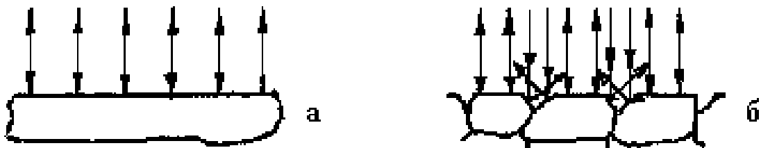
Рисунок 1- Схема отражения световых лучей от поверхности полированного (а) и подвергнутого травлению (б) микрошлифа.
