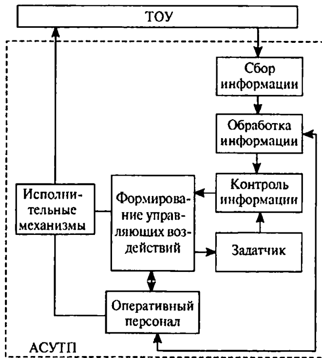
Рис. 1. Обобщенная функциональная структура АСУТП
