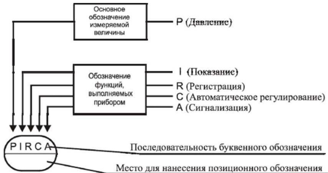
Рис. 1. Последовательность буквенных обозначений средств измерения и регулирования
