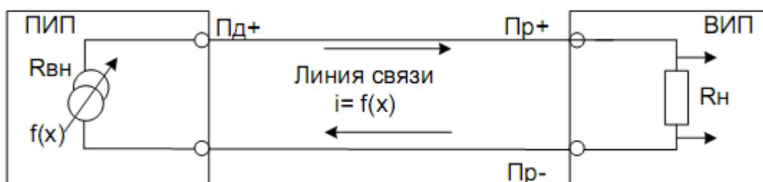
Рис. 1. Двухпроводная токовая связь ПИП и ВИП
