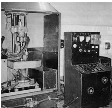
Рис. 2. Установка для восстановления цилиндров ДВС гальвано механическим способом
