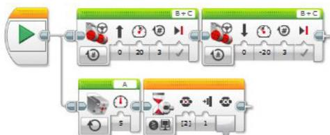
Рис. 4. Программа для демонстрации прямолинейного равномерного движения
