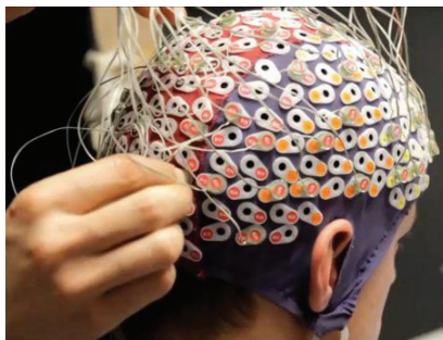
Рис. 2. Устройство для монтирования электродов ЭЭГ на поверхности черепа человека, включающее в себя повышенное число отведений
