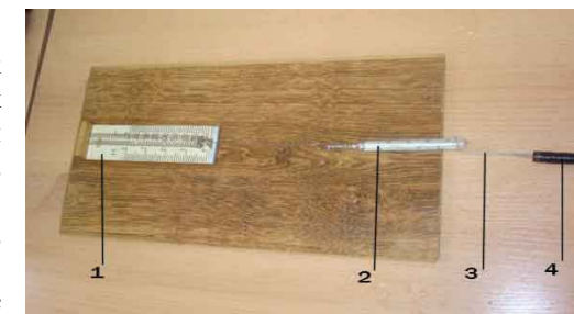
Рис. 3. 1 - пружинный динамометр, 2- градусник, 3- эндоскопическая петля, 4- эндоскоп.
