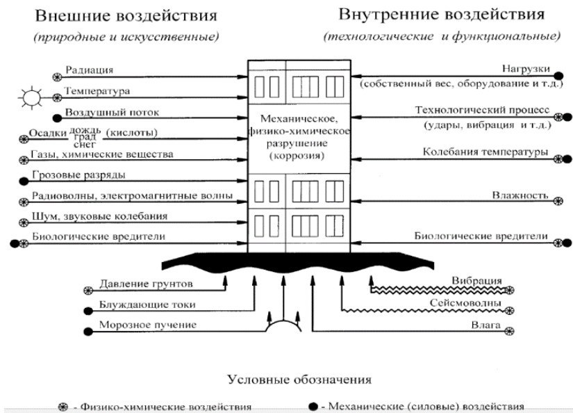
Рис. 1. Факторы, воздействующие на здания и сооружения
