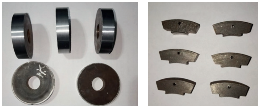
Рис. 17 – Фото образцов для испытаний на износ: а – ролики покрытые хромом, б – колодка (контртело)
