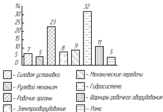
Рис. 2. Структура отказов на примере самосвала КамАЗ-5511
