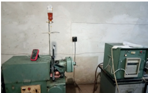
Рис. 15. Машина трения СМЦ-2М для испытания хромовых покрытий на износ
