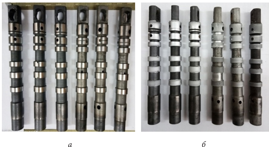
Рис. 50. Внешний вид золотников: а – подготовленных для хромирования, б – покрытых хромом
