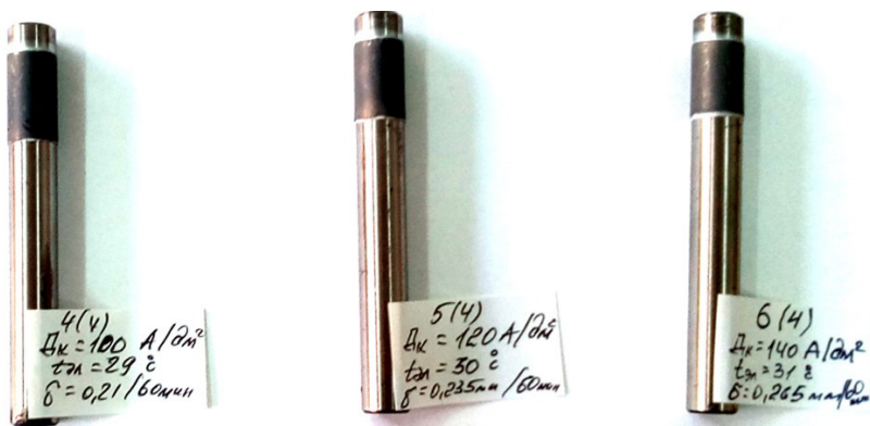
Рис. 43. Образцы для исследования прочности сцепления на различных режимах
