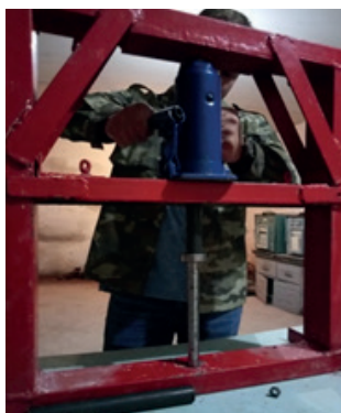
Рис. 13. Пресс на 10 тс с оправкой для испытаний на прочность сцепления
