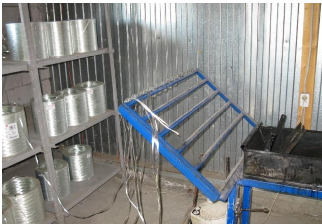
Рис. 1. Пропиточная ванна с натяжным устройством; устройство спиральной намотки; выравнивающее устройство
