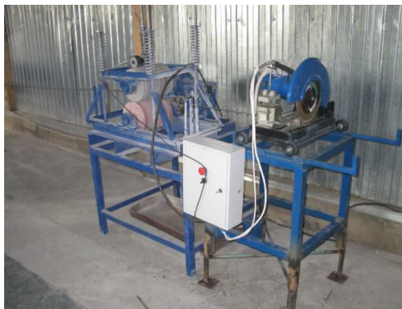
Рис. 3. Тянущее устройство; узел резки
