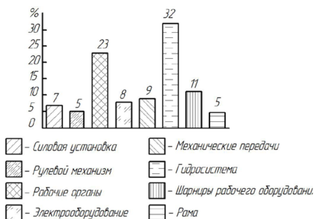
Рис. 2. Структура отказов на примере самосвала КамАЗ-5511
