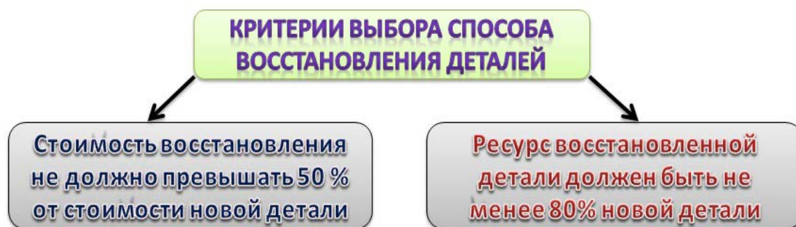
Рис. 1. Критерии выбора способа восстановления деталей автомобилей
