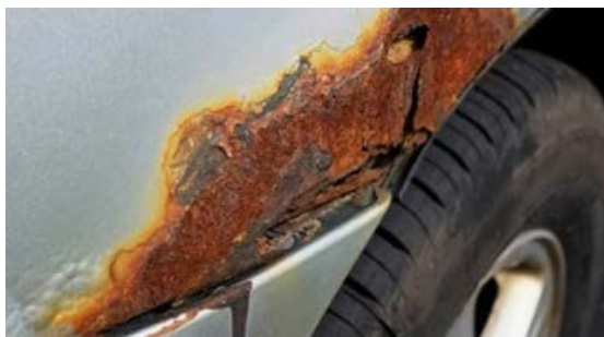
Рис. 1. Коррозия на корпусе
