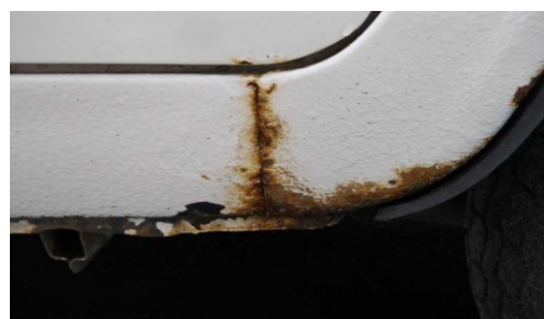
Рис. 4. Трещина на корпусе транспортного средства
