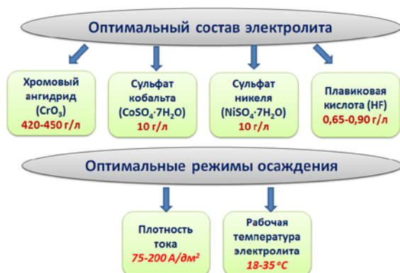
Рис. 7. Результаты оптимизации состава электролита хромирования и режимов осаждения
