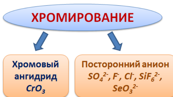
Рис. 6. Условие получения хромовых покрытий
