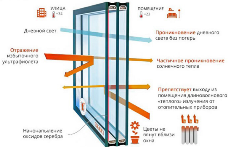
Рис. 5. Свойства мультифункционального стекла
