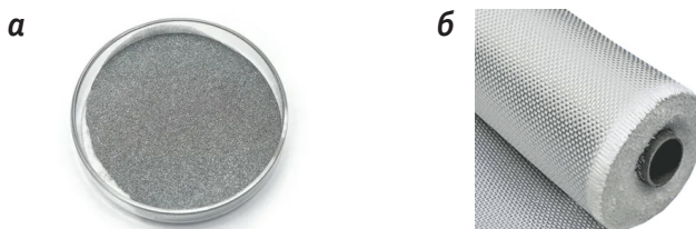
Рис. 3. Дисперсные и тканые наполнители а) – дисперсный наполнитель (алюминиевая пудра), б) тканый наполнитель (стеклоткань)
