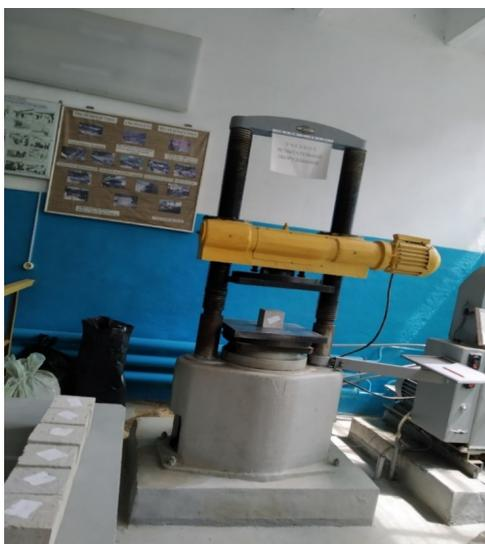
Рис. 5. Гидравлический пресс ПСУ-125
