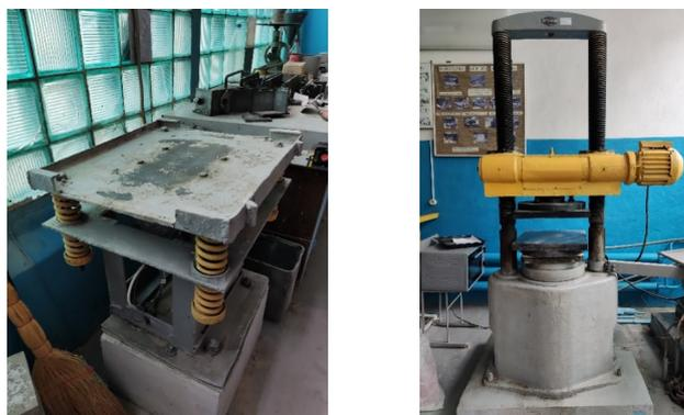
Рис. 2. Необходимое оборудование вибростол, гидравлический стол.
