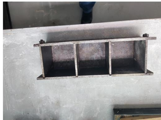
Рис.3. Форма для изготовления бетонных кубиков
