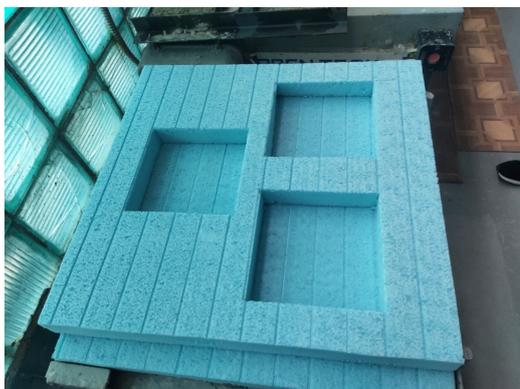
Рис. 2. Форма для приготовления тротуарной плитки
