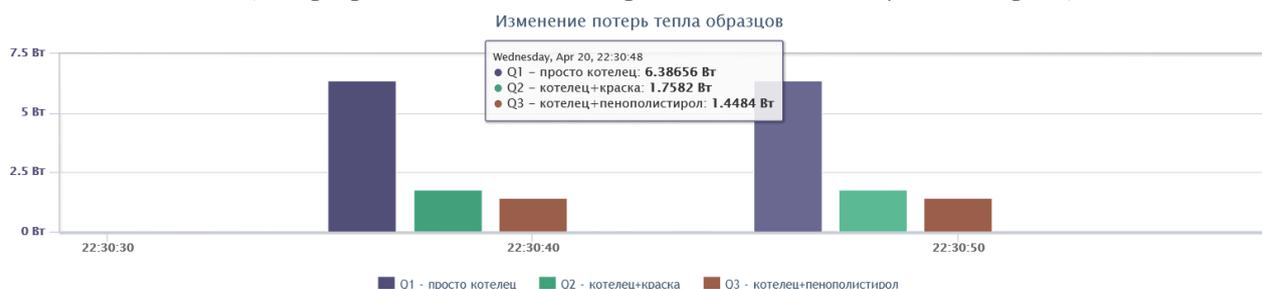
Рис. 123. Укрупненный участок графика потерь тепла всех образцов.
