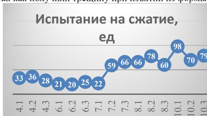
Рис. 8. График зависимости прочности на сжатие от количества цемента в составе 60%.
