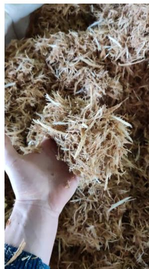
Рис. 1. Фракции заполнителя древесностружечные опилки.
