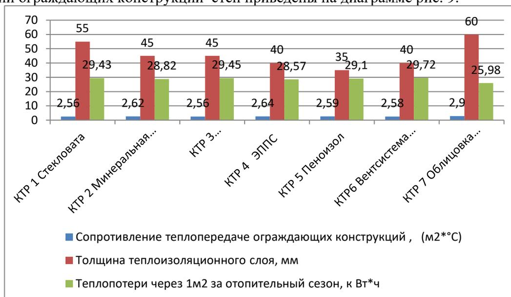
Рис. 9 Диаграмма сравнения теплотехнических характеристик конструктивно-технологических решений теплоизоляции наружных стен.
