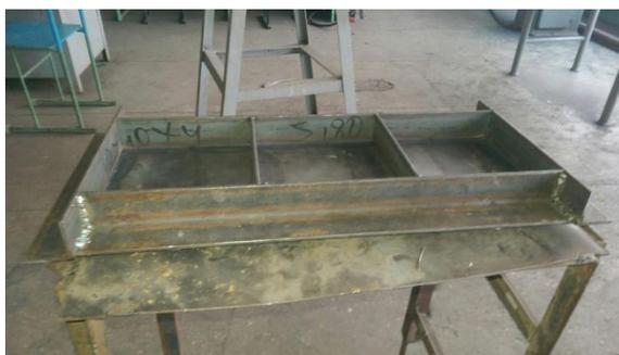
Рис. 3. Формы для изготовления образцов.
