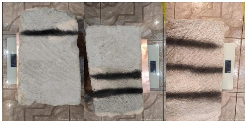
Рис.6. Взвешивание всех образцов для вычисления плотности.
