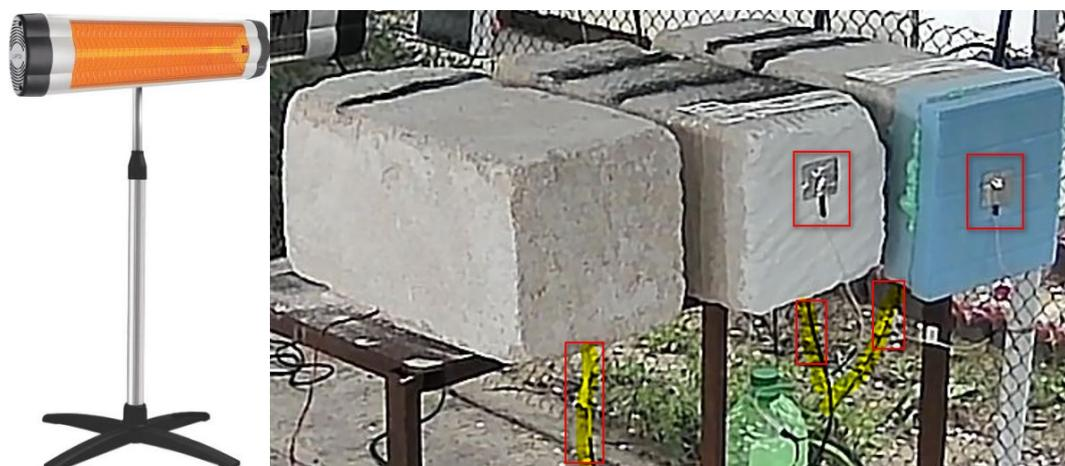
Рис. 92. УФО обогреватель и образцы с подключенными датчиками измерения температур.
