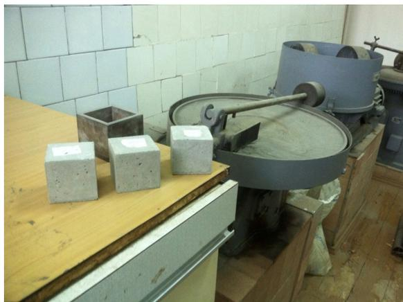
Рис. 9. Круг истирания ЛКИ-2 и образцы для испытания.
