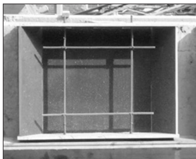
Рис. 3. Специальная форма для изготовления образцов для испытаний с фасками и щелями в бортах для отвода отскока бетона при формовании
