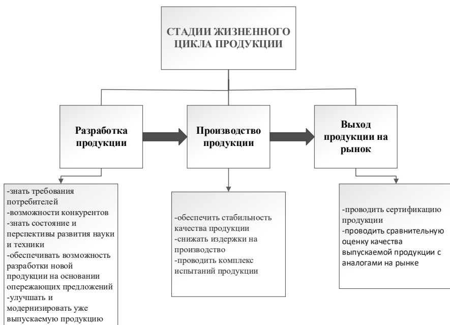
Рис. 1. Задачи технического сопровождения производства электромашиностроительной продукции, на различных стадиях жизненного цикла продукции
