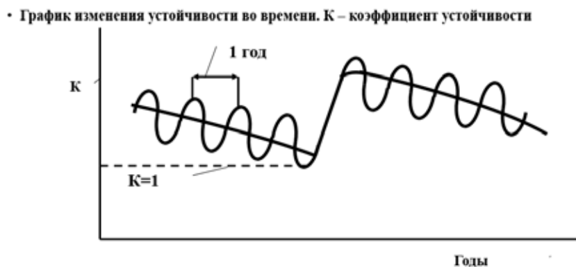
Рис. 1. Схема изменения устойчивости грунтового сооружения во времени
