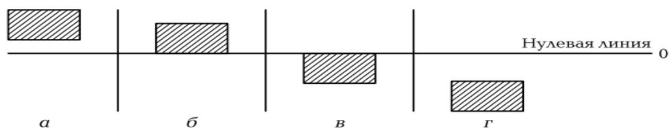
9. Посадка, при которой до сборки размер вала больше размера отверстия и поле допуска вала располагается выше поля допуска отверстия, называют ...
