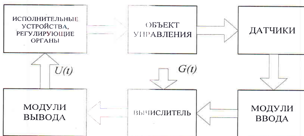
Рисунок 2. Структура цифровой системы управления
