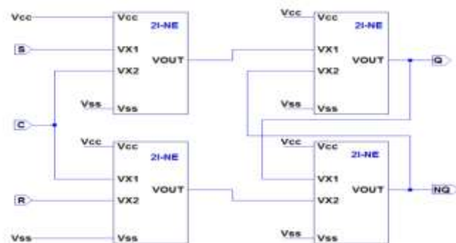
Рис. Схема одноступенчатого тактируемого R-S триггера
