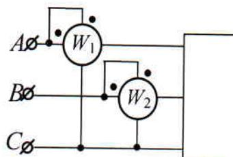
4. Потребитель подключен к сети с симметричной системой линейных напряжений. Токи в фазах потребителя равны 5 А. Определить токи в линейных проводах?
