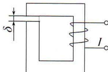
8. Длина стальной части сердечника  $l_c = 138$  см, воздушный зазор
