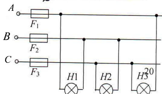
Б Лампа  $H_2$  перегорает от перенапряжения;
