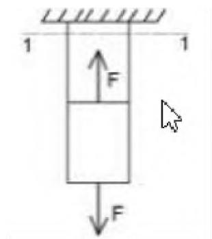
15. Чему равна продольная сила  $N$  в сечении I-I, если  $F=10\text{кН}$ ,  $g=5\text{кН/м}$ ,  $L=1\text{м}$ ?
