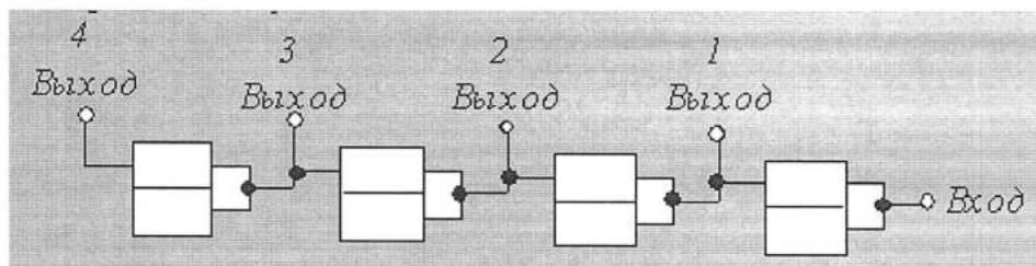
Двоичный счетчик установлен в нулевое состояние. После подачи на вход одиннадцати импульсов на выходе счетчика будет состояние
