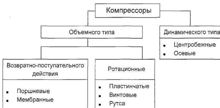
Рис. 5.2. Классификация компрессоров
