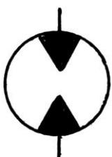
Гидромотор нерегулируемый с реверсивным потоком
