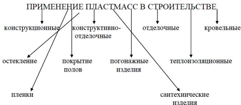
*Схема 33. Применение пластмасс в строительстве*
