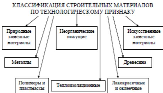
Схема 1. Классификация строительных материалов по технологическому признаку
