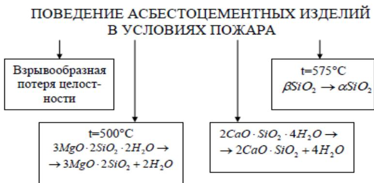
Схема 15. Поведение асбестоцементных изделий в условиях пожара
