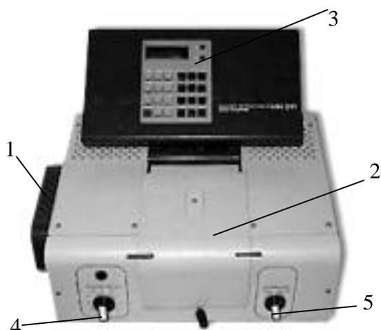
**Рис. 4.2. Фотоколориметр КФК-2МП:** 1 – отделение для источника излучения; 2 – кюветное отделение; 3 – дисплей; 4 – ручка переключения светофильтров; 5 – ручка переключения рабочего режима.
