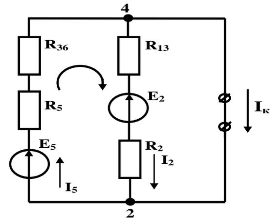
Рис.12. Схема линейной электрической цепи в режиме короткого замыкания.
