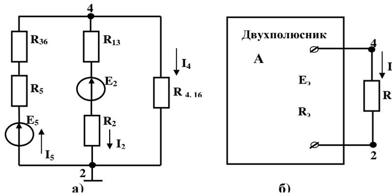
Рис.10: а) Исходная схема линейной электрической цепи постоянного тока;
