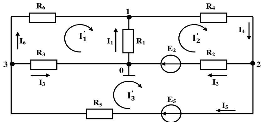
Рис.2. Сложная линейная электрическая цепь постоянного тока
