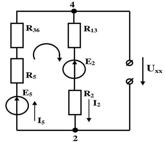
Рис.11. Схема линейной электрической цепи в режиме холостого хода
