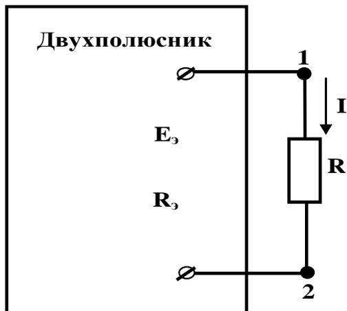
Рис.9. Эквивалентная схема двухполюсника с исследуемой ветвью.
