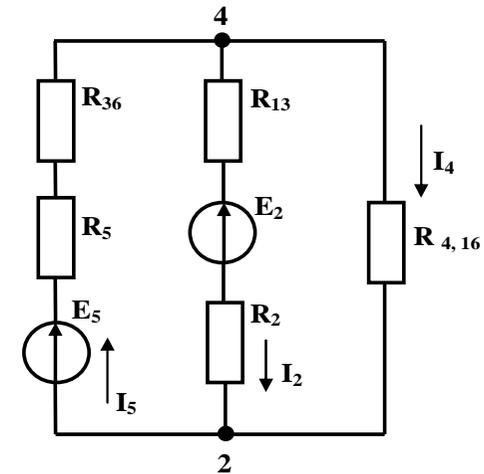
Рис.13. Сложная электрическая цепь, имеющая два узла.
