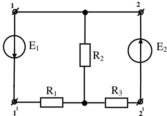
Рис. 22. Сложная электрическая цепь с  $\Gamma$  - образным пассивным четырехполюсником
