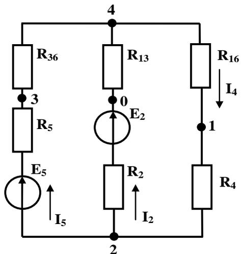
Рис.6. Преобразованная линейная электрическая цепь постоянного тока
