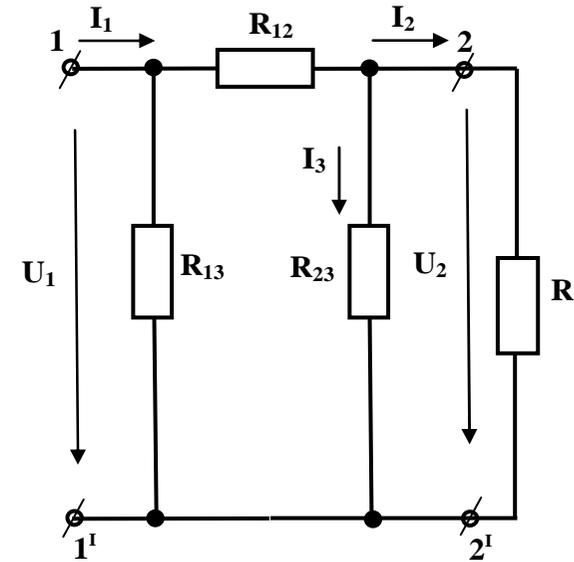
Рис.21. П – образная схема замещения четырехполюсника
