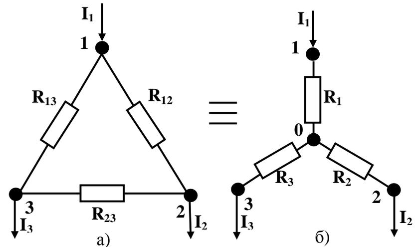
Рис.4. Схемы соединения резисторов треугольником (а) и звездой(б)
