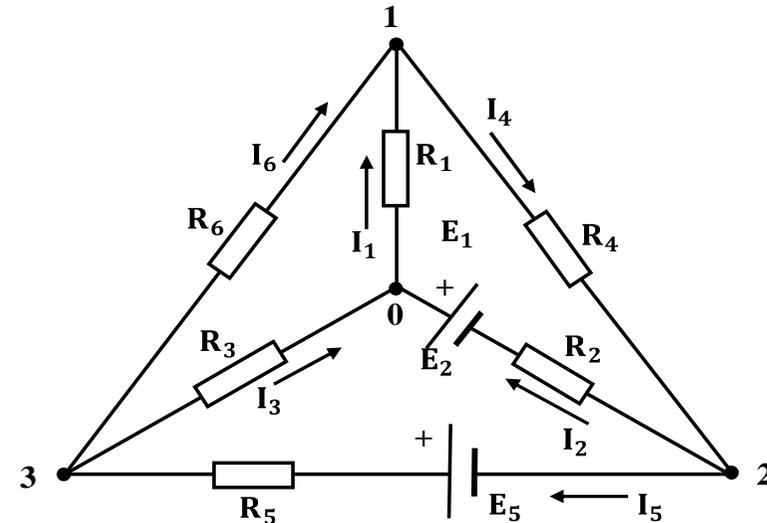
Рис.5. Линейная электрическая цепь постоянного тока
