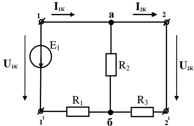
Рис. 24. Схема Т – образного четырехполюсника в режиме КЗ
