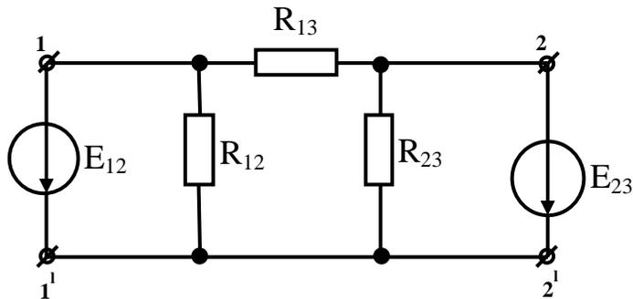
Рис. 25. Сложная электрическая цепь с  $\Pi$  – образным пассивным четырехполюсником
