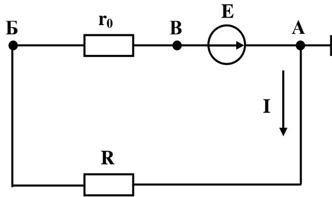
Рис.15. Неразветвленная электрическая цепь
