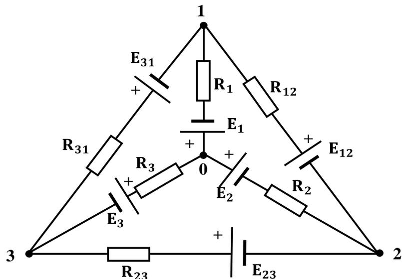
Рис.1. Линейная электрическая цепь постоянного тока.
