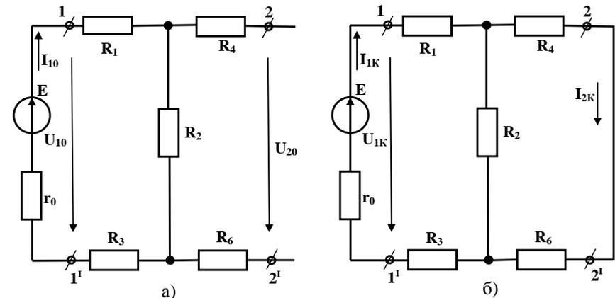
Рис.19. Схемы четырехполюсника в различных режимах:
