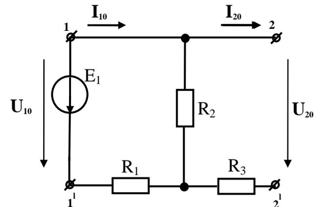
Рис. 23. Схема T – образного четырехполюсника в режиме XX
