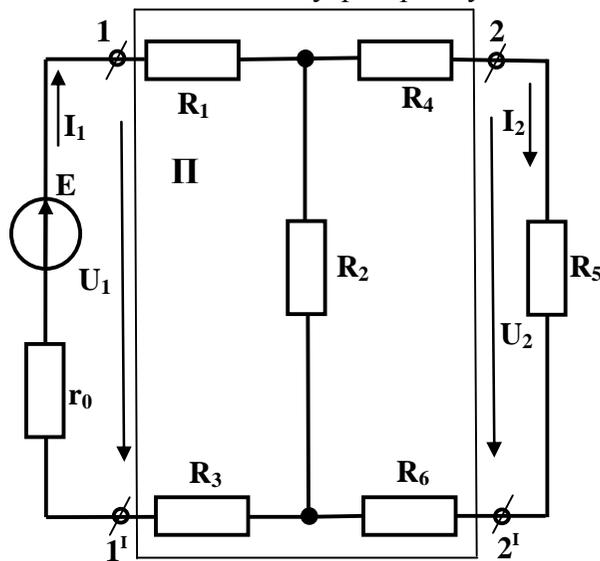
Рис.18. Схема пассивного четырехполусника
