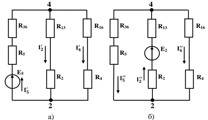
Рис.7. Частные схемы исходной линейной электрической цепи постоянного тока.
