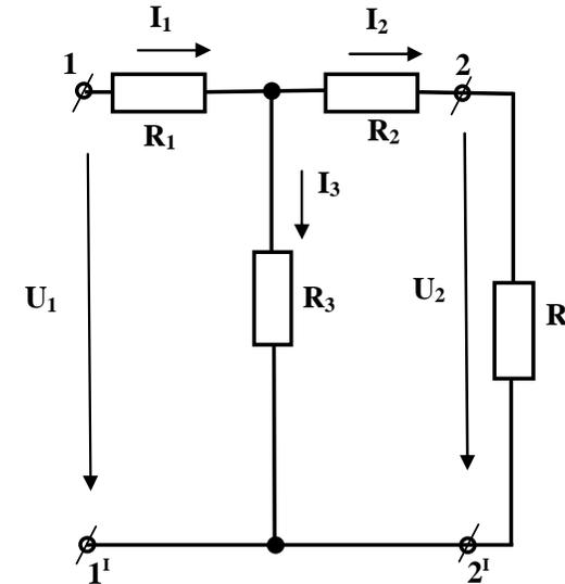
Рис.20. T – образная схема замещения четырехполюсника
