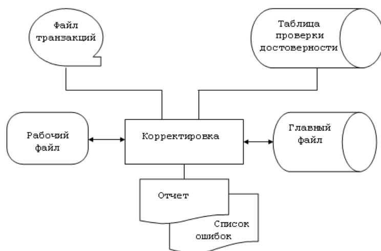
Рисунок 3.6 – Пример оформления схемы ресурсов системы согласно ГОСТ
