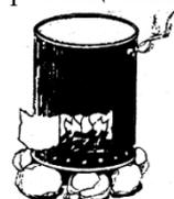
**«Печка бродяги».** Пробейте отверстия в днище и по окружности внизу 15—20-литровой банки из-под моторного масла. На высоте 5 см от днища вырежьте отверстие, через которое можно будет поддерживать огонь. Поставьте банку на круг из камней, чтобы обеспечить приток воздуха снизу.
