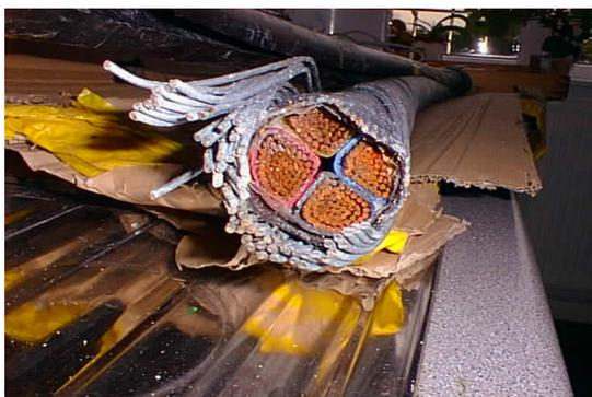
Рисунок 22. Коррозия металлической оболочки кабеля
