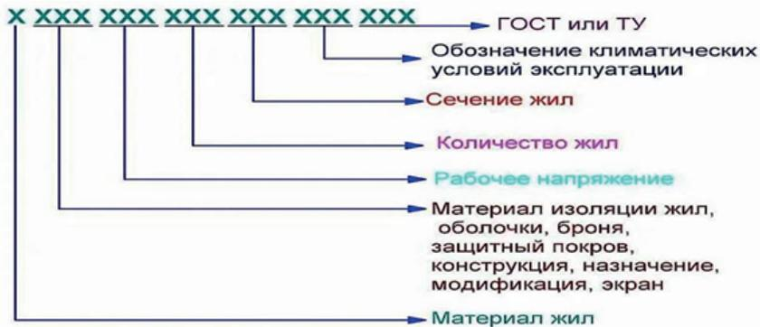
Рисунок 15. Схема обозначения для кабелей
