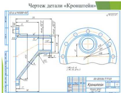
Рис. 12. 2D чертеж изготавливаемой детали
