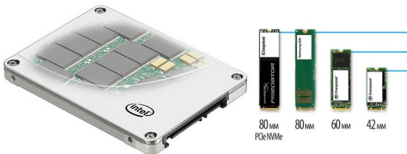
Рис. 14. SSD – твердотельный накопитель
