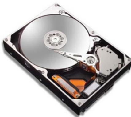
Рис. 13. Накопитель на жестком диске (HDD)
