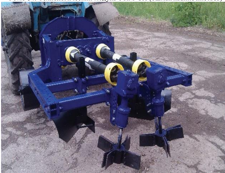
Фото 35. Технологический модуль УКМ-РК (раскрытие корневой системы маточника)
