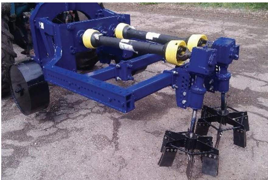
Фото 30. Технологический модуль УКМ-ВР (весеннее раскрытие маточников)
