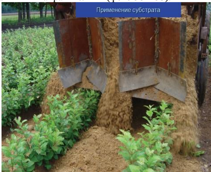
Фото 38. Машина для внесения в междурядья маточника органического субстрата (опилок, торфа и т.д.)
