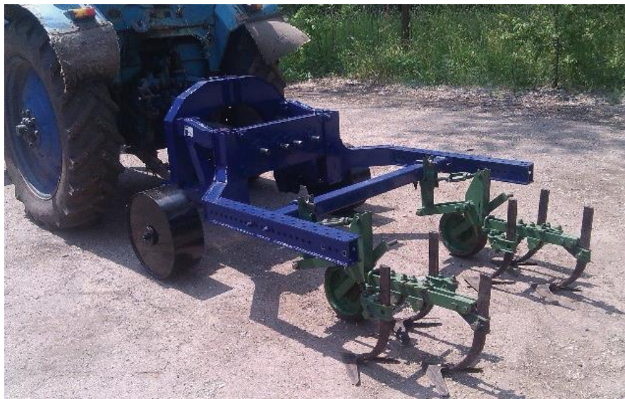
Фото 32. Технологический модуль УКМ-МО (междурядная обработка маточника)
