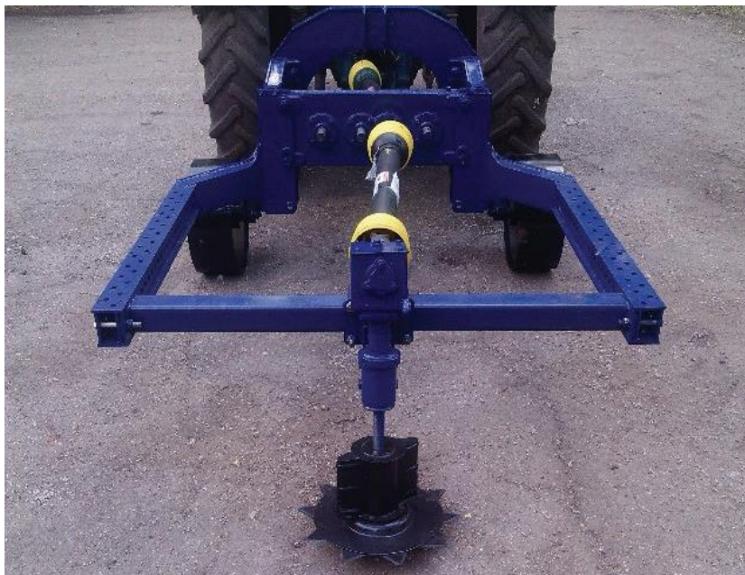
Фото 36. Технологический модуль УКМ-ОО (отделение отводков маточника)
