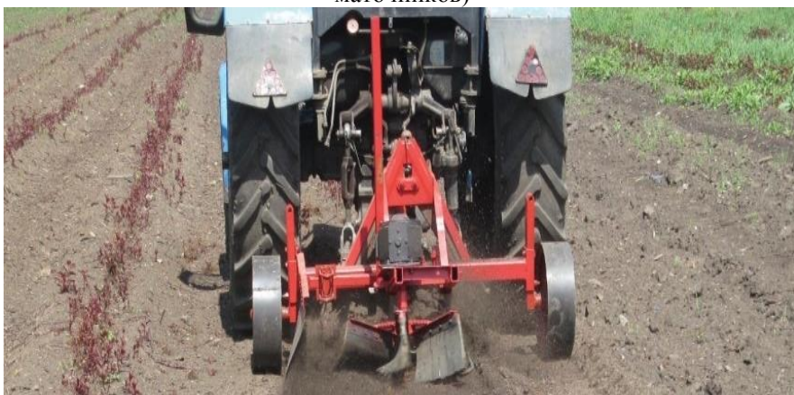
Фото 31. Технологический модуль УКМ-ВР (весеннее раскрытие маточников)
