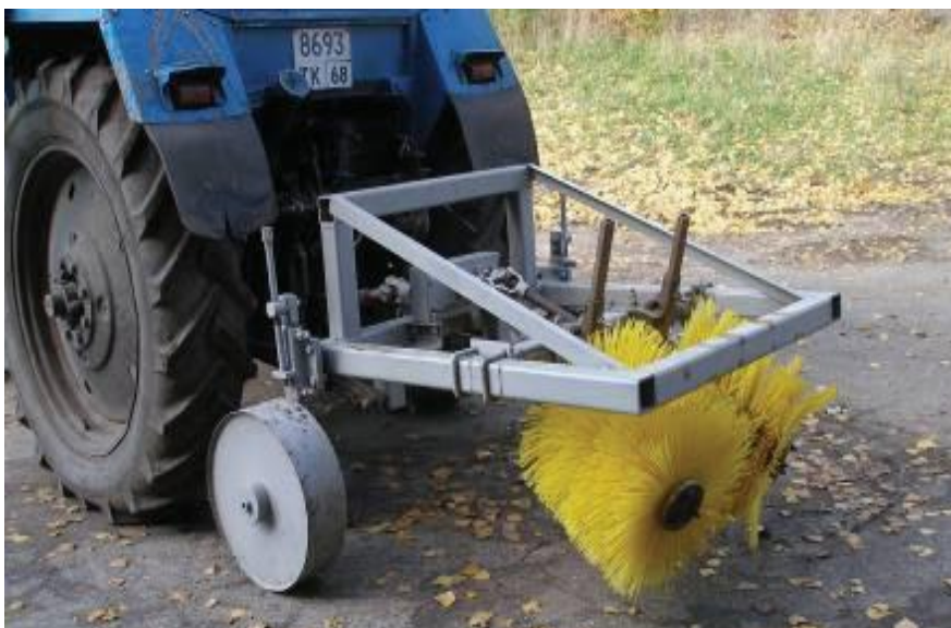
Фото 34. Технологический модуль УКМ-ОЛ (ошмыгивание листьев)
