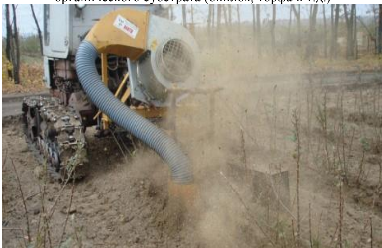
Фото 39. Машина для разокучивания маточника от органического субстрата пневматическая
