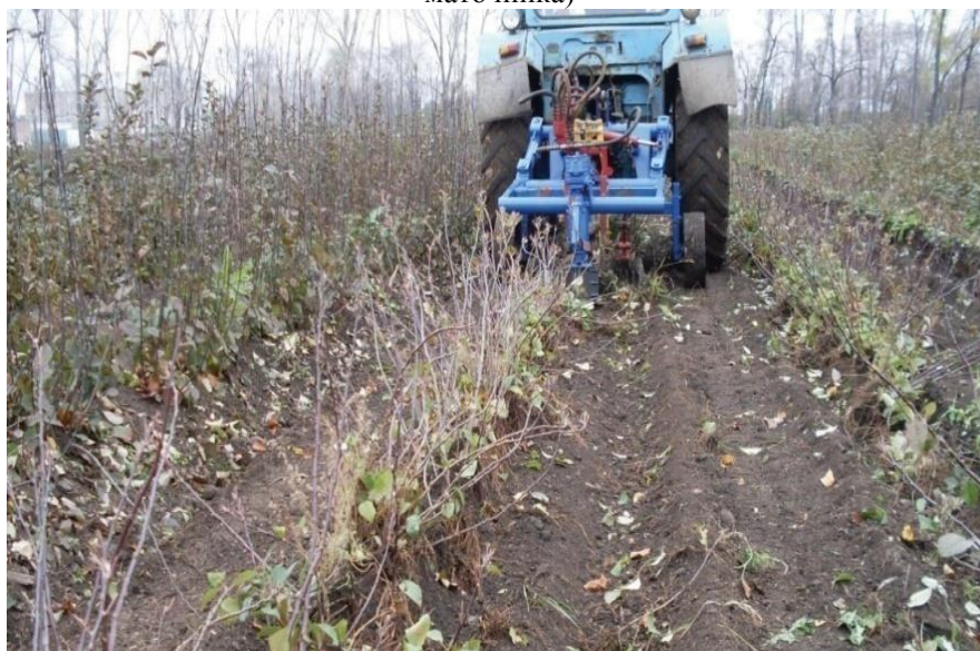
Фото 37. Технологический модуль УКМ-ОО (отделение отводков маточника)
