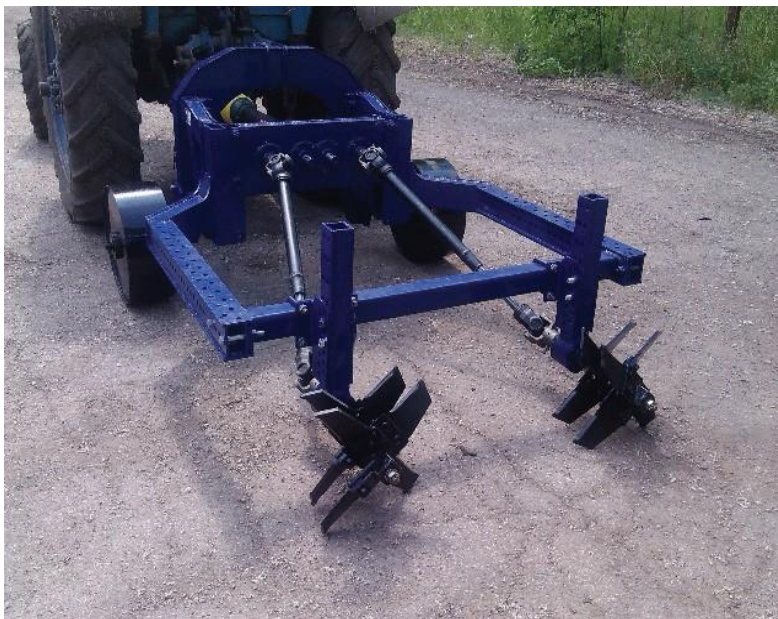
Фото 43. Технологический модуль УКМ-О (окучивание маточника)
