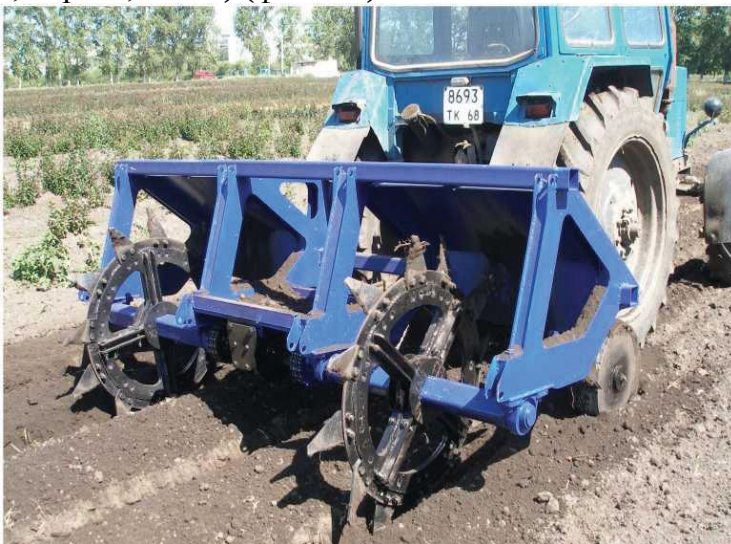
Фото 28. Бороздонарезчик БР. Предназначен для нарезания борозд для посадки подвоев плодовых культур
