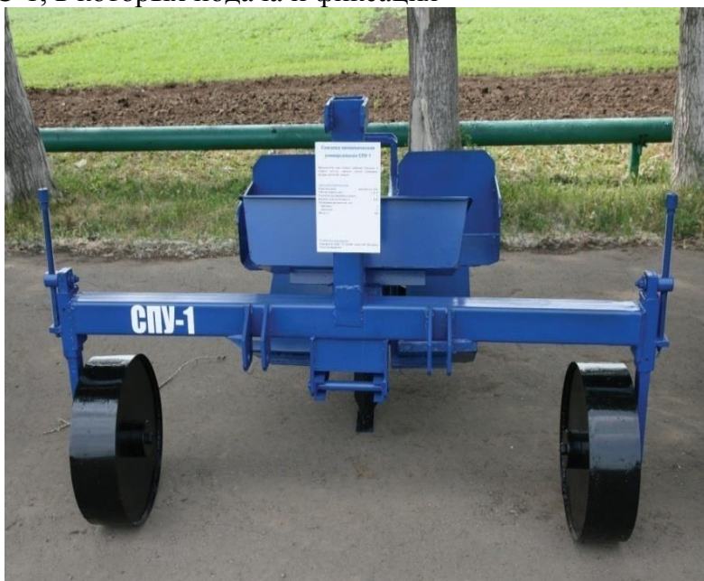
Фото 29. Сажалка питомническая универсальная СПУ-1
