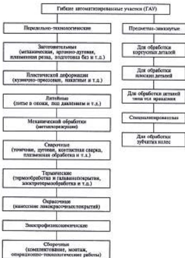
Рис. 18. Классификация ГАЗ по функциональному назначению
