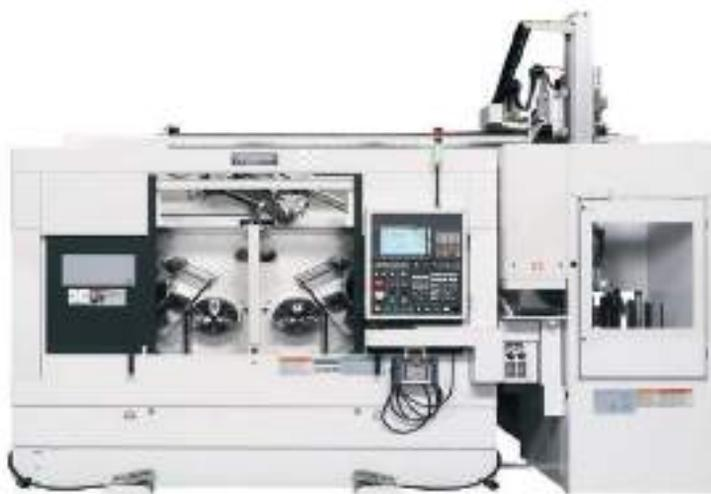
Рис. 46. *Обработка заготовки на многооперационном станке токарного типа с добавлением фрезерного шпинделя*
