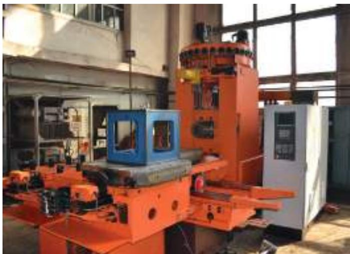
Рис. 49. Многооперационный станок фрезерно-сверлильно-расточной группы горизонтальным шпинделем
