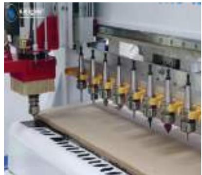
Рис. 65. Инструментальный магазин-накопитель стеллажного вида на многооперационном станке с ЧПУ
