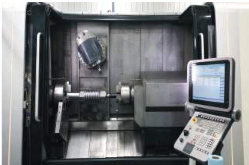
Рис. 44. Многооперационный станок с ЧПУ токарного типа с добавлением фрезерного шпинделя
