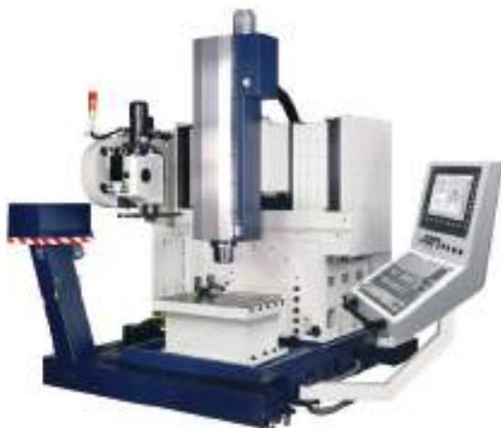
Рис. 47. Многооперационный станок фрезерно-сверлильно-расточной группы для обработки заготовок корпусных деталей с вертикальным шпинделем
