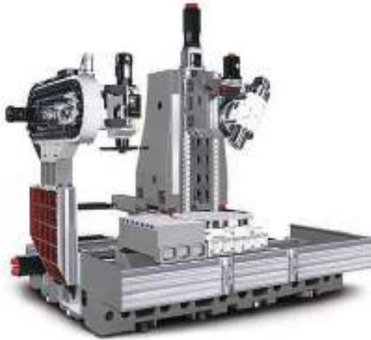
Рис. 66. Устройства автоматической смены инструментов с автооператорами на многооперационном станке с ЧПУ
