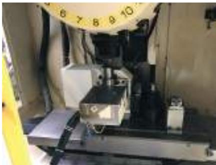
*Рис. 67. Кодирование позиций инструментального магазина-накопителя на многооперационном станке с ЧПУ*
