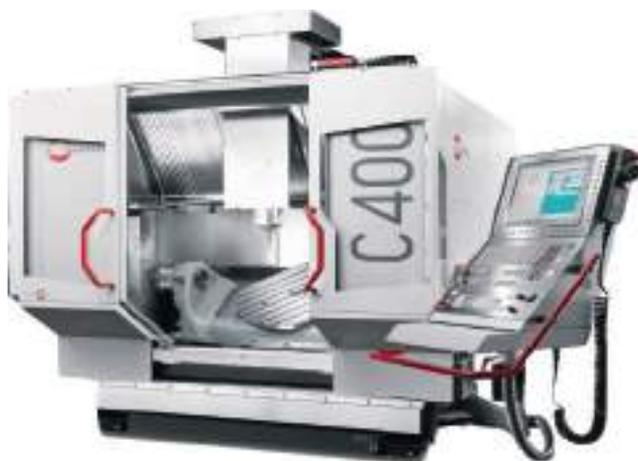
Рис. 52. Многооперационный станок с поворотным столом
