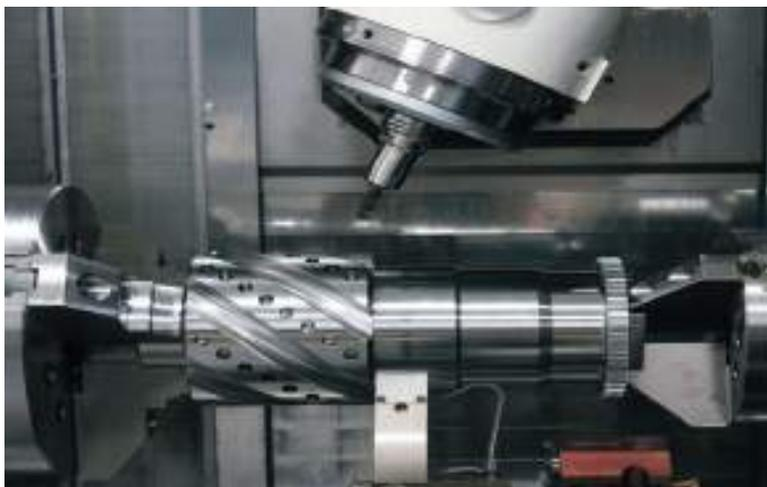
Рис. 45. *Обработка заготовки на многооперационном станке токарного типа с добавлением фрезерного шпинделя*
