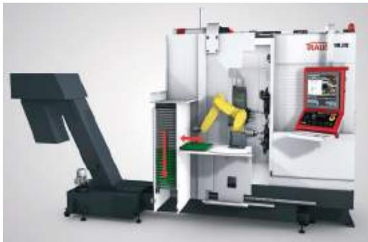
Рис. 42. Многооперационный станок, оснащённый промышленным роботом
