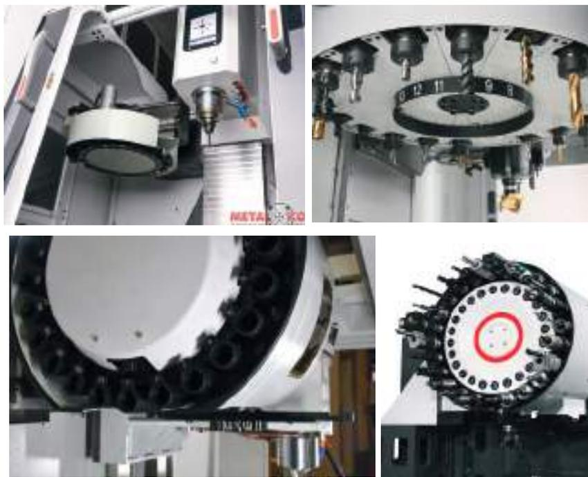
Рис. 63. Инструментальный многоярусный магазин-накопитель дискового вида
