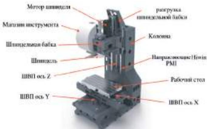
Рис. 41. Компоновка многооперационного (многоцелевого) станка
