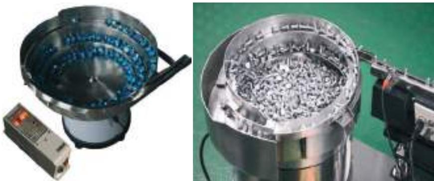
Рис. 90. Вибробункерные загрузочные устройства
